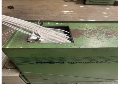
Figure III.4 : Les joncs des mélanges PEHD/PEBD placés dans le broyeur
