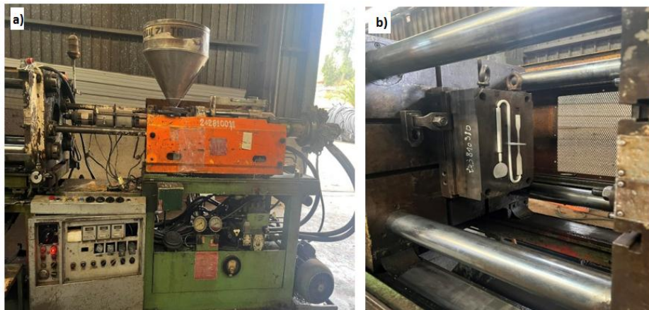
Figure III.5 : Presse à injection
