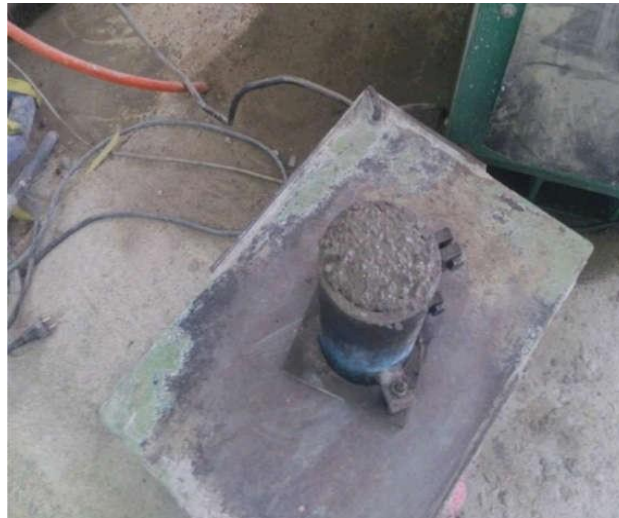
Figure IV.2 Vibration des éprouvettes
