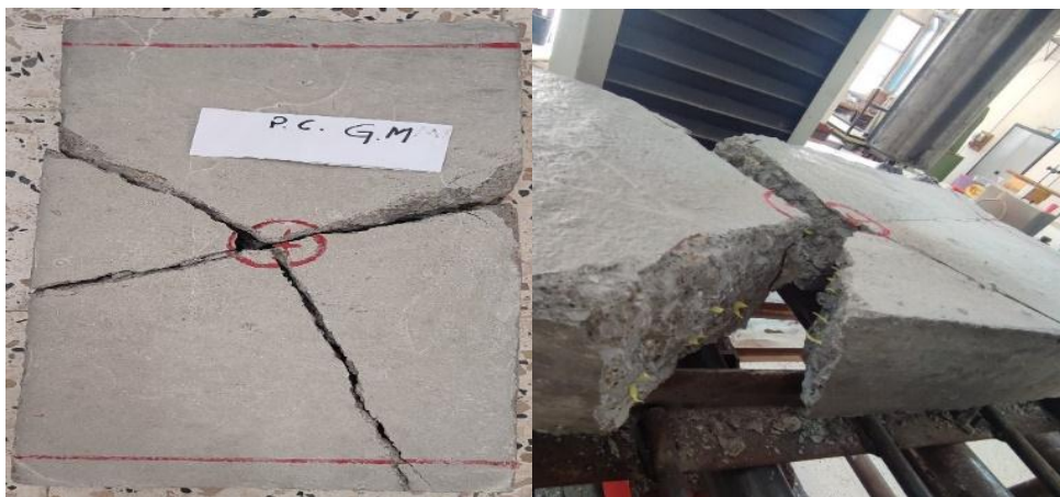
Figure V.15 Mode de rupture de dalles avec des (GPP/GM)
