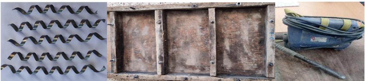
Figure V.1 Moules, dalles, fibres utilisées et le vibreur.
