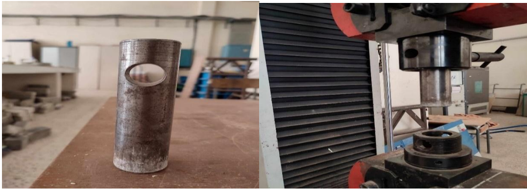
Figure V.4 La tige de poinçonnement utilisée.
