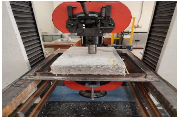
Figure V.6 Exemple d'essai de poinçonnement centré.
