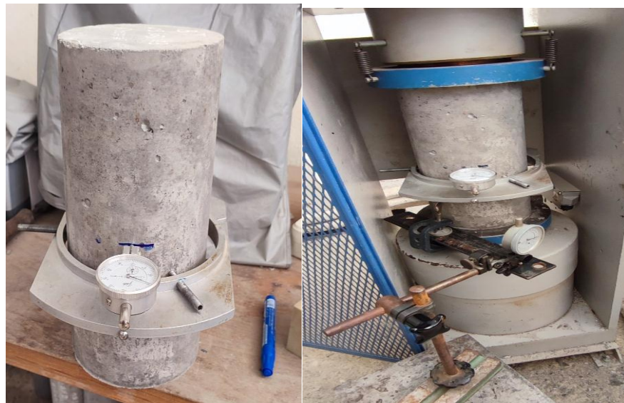
Figure IV.3 Ecrasements de l'éprouvette
