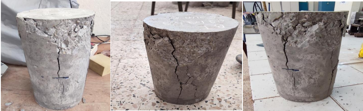
Figure IV.4 Rupture de l'éprouvettes béton témoin sous sollicitation de compression
