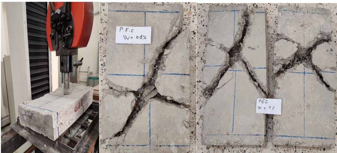
Figure V.19 Exemple du mode de rupture des dalles testée lors des essais en poinçonnement excentré (série 1)
