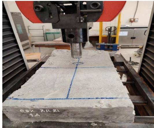
Figure V.18 Exemple d'essai de poinçonnement excentré
