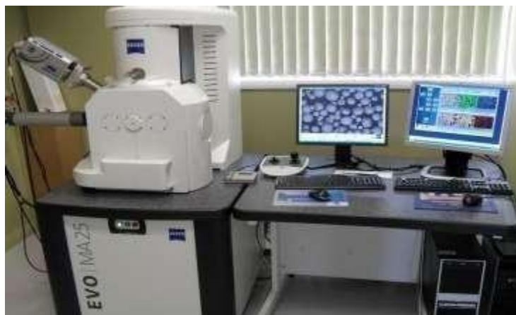
Figure II.11 Photographie du microscope électronique à balayage (MEB) utilisé.
