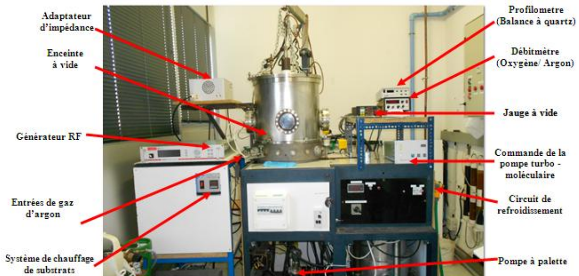
Figure 3. Dispositif expérimental de la pulvérisation cathodique du laboratoire CNRS-PROMES de Perpignan.
