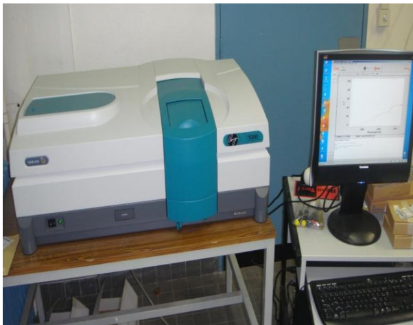
Figure 10. Photographie du spectrophotomètre qu'on a utilisé (INSA-TOULOUSE) et illustration du principe de la Spectrophotométrie.
