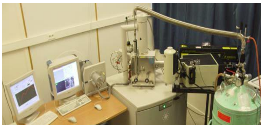
Figure 11. Photographie du système de la cathodoluminescence qu'on a utilisé (INSA-TOULOUSE) et illustration de son principe.
