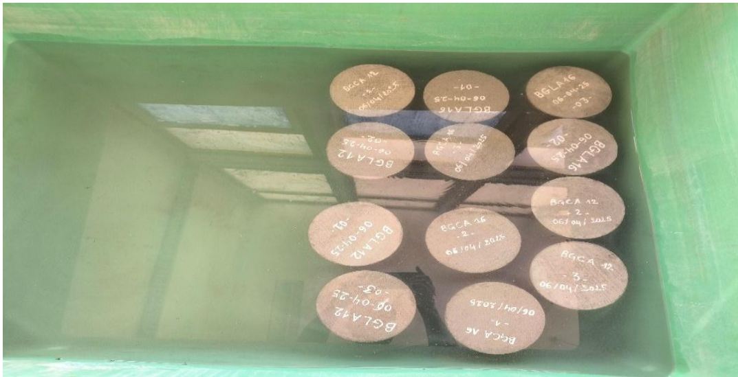
Figure II-29 cure par immersion
