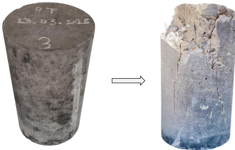
Figure III-28 éprouvettes du béton témoin avant et après écrasement
