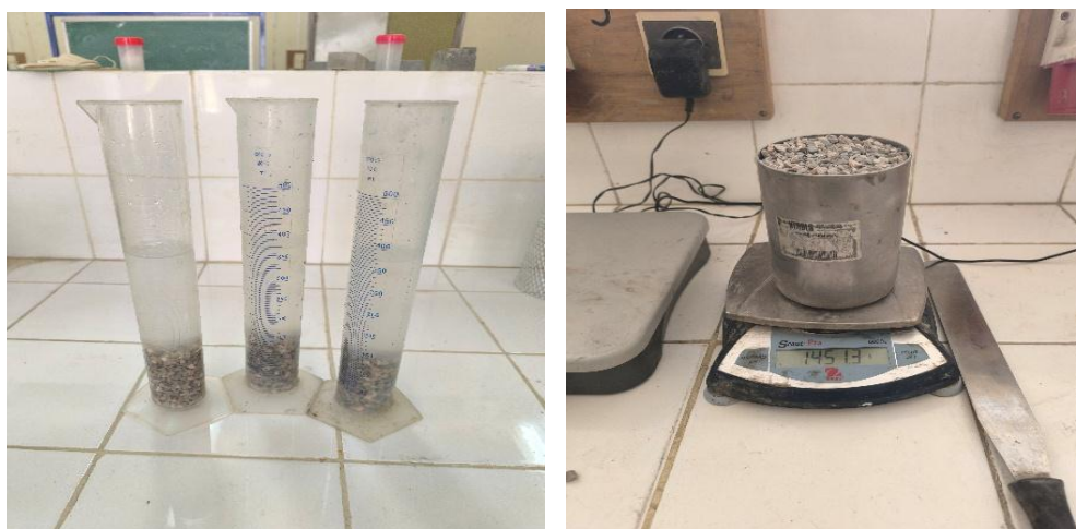
Figure II-13 résultats de masse volumique absolue et apparente du gravier (3/8)
