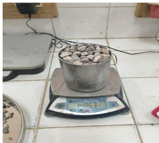
Figure II-14 résultats de masse volumique absolue et apparente du gravier (8/15)
