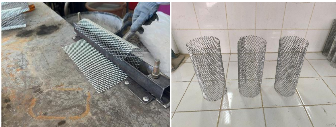
Figure II-24 mise en forme des cylindres de grille
