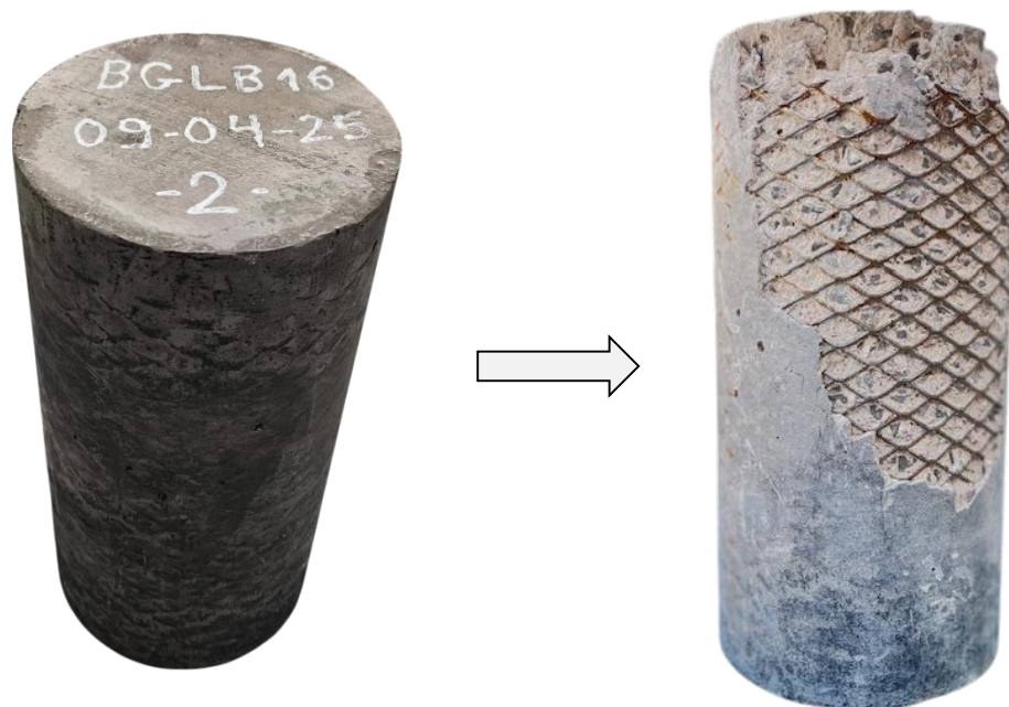
Figure III-34 l'éprouvette BGLB16 avant et après l'écrasement
