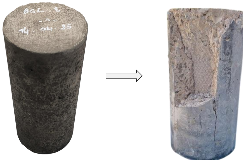
Figure III-38 l'éprouvette BGLD8 avant et après l'écrasement
