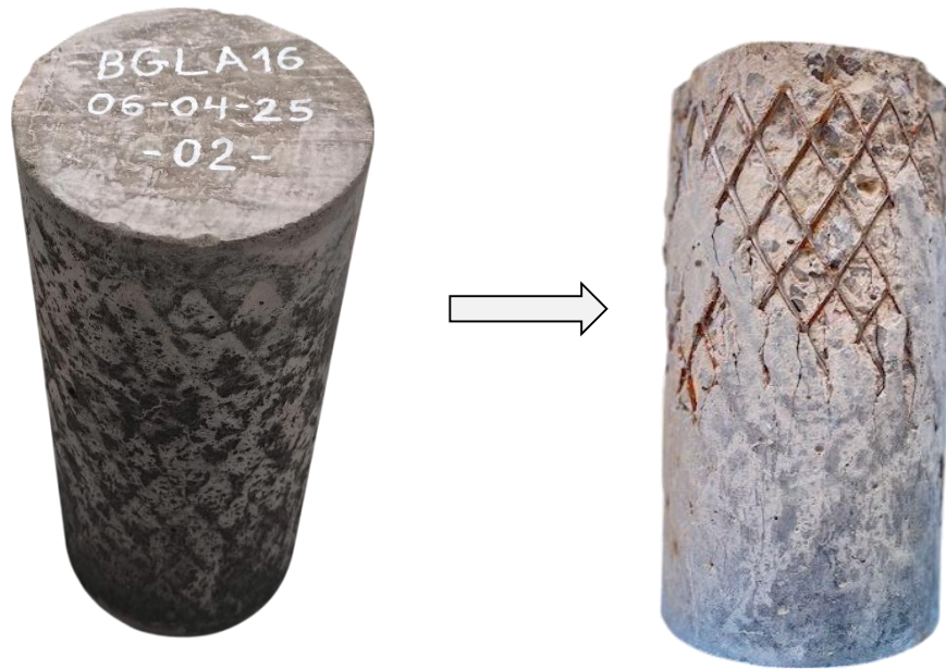
Figure III-31 l'éprouvette BGLA16 avant et après l'écrasement
