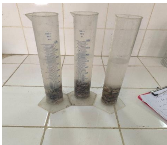
Figure II-14 résultats de masse volumique absolue et apparente du gravier (8/15)
