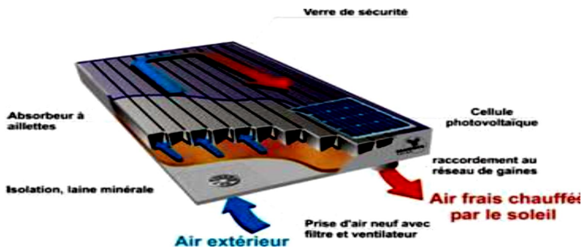
Figure I-16 :Capteur solaire à air.
