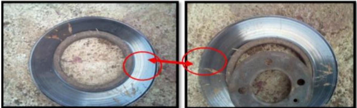
Fig.III.7. Disque endommagé par le fer d'une plaquette.
