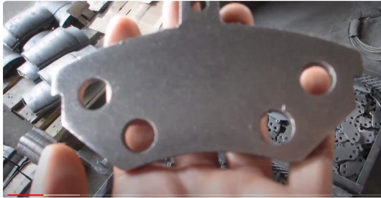
Fig.VI.3. Support métallique bien découpé.
