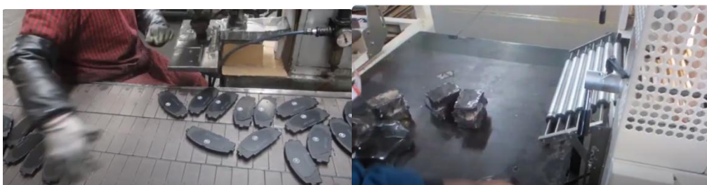
Fig.VI.7. Marquage et emballage des plaquettes.
