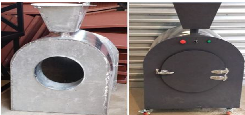
Figure III-28 : Couvercle du moulin avant et après le soudage
