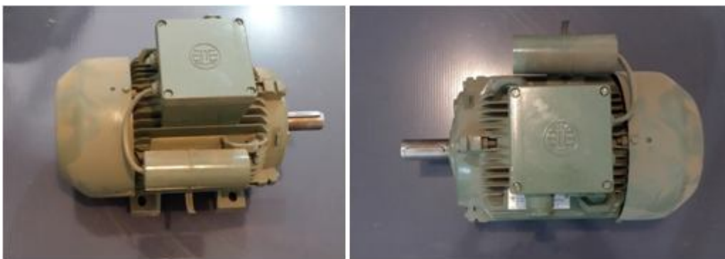
Figure III-5 : Moteur électrique du moulin.
