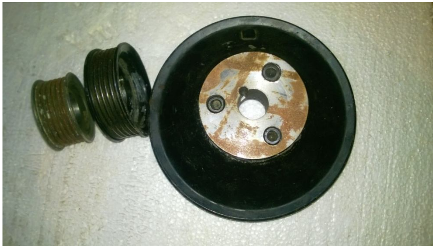
Figure III-13 : Poulies striées du moulin
