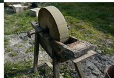
Une meule à main utilisée pour affuter les outils
