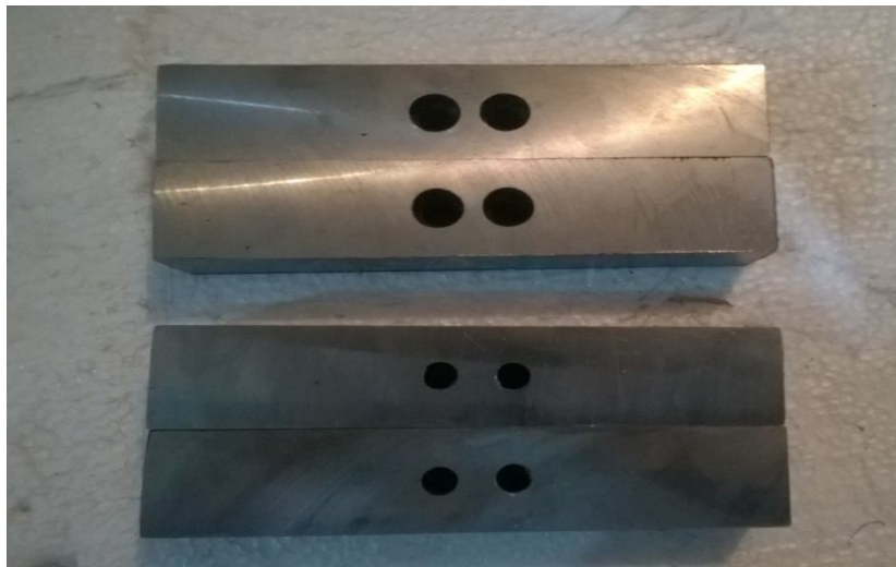
Figure III-32 : Couteaux mobiles du moulin
