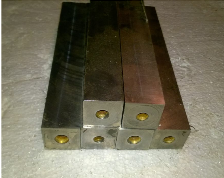
Figure III-33 : Couteaux fixes du moulin
