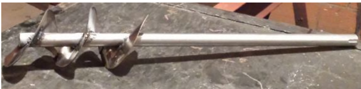
Figure III-30 : Arbre d'entrainement d'olives
