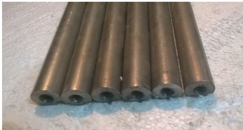
Figure III-34 : Guide tamis du moulin
