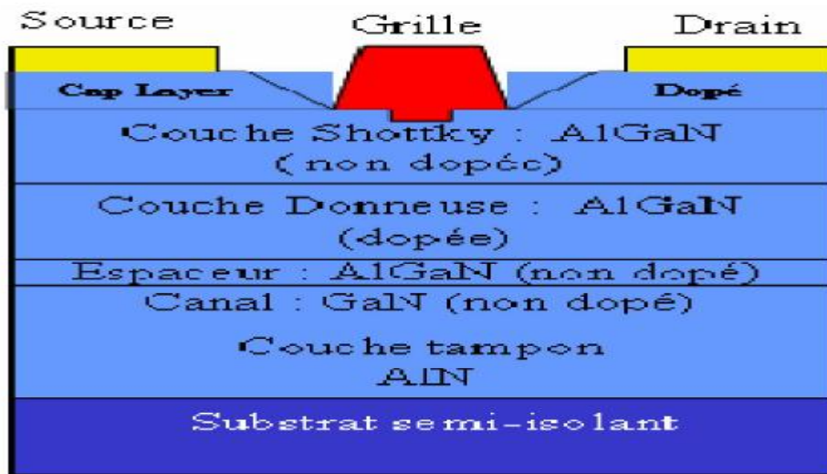
Figure II. 5: Structure et différentes couches du HEMT AlGaN/GaN
