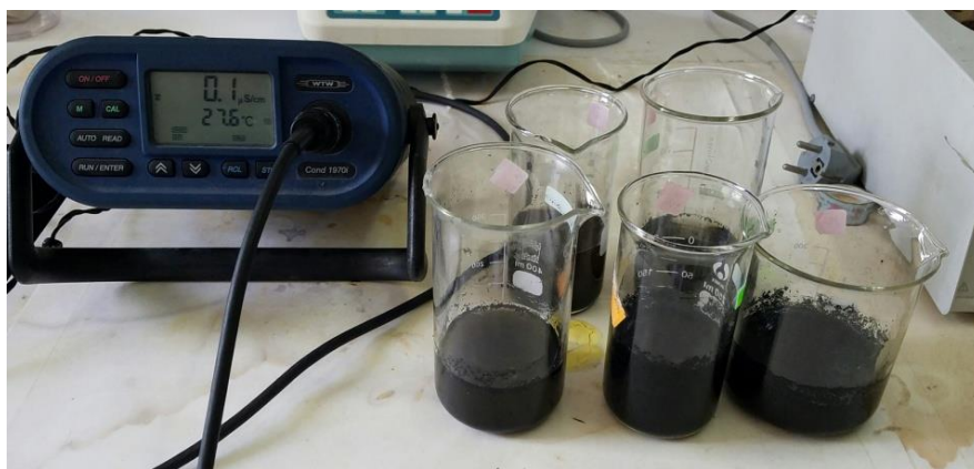
Figure 22 : mesure de la CE avec un conductimètre [originale, 2022]
