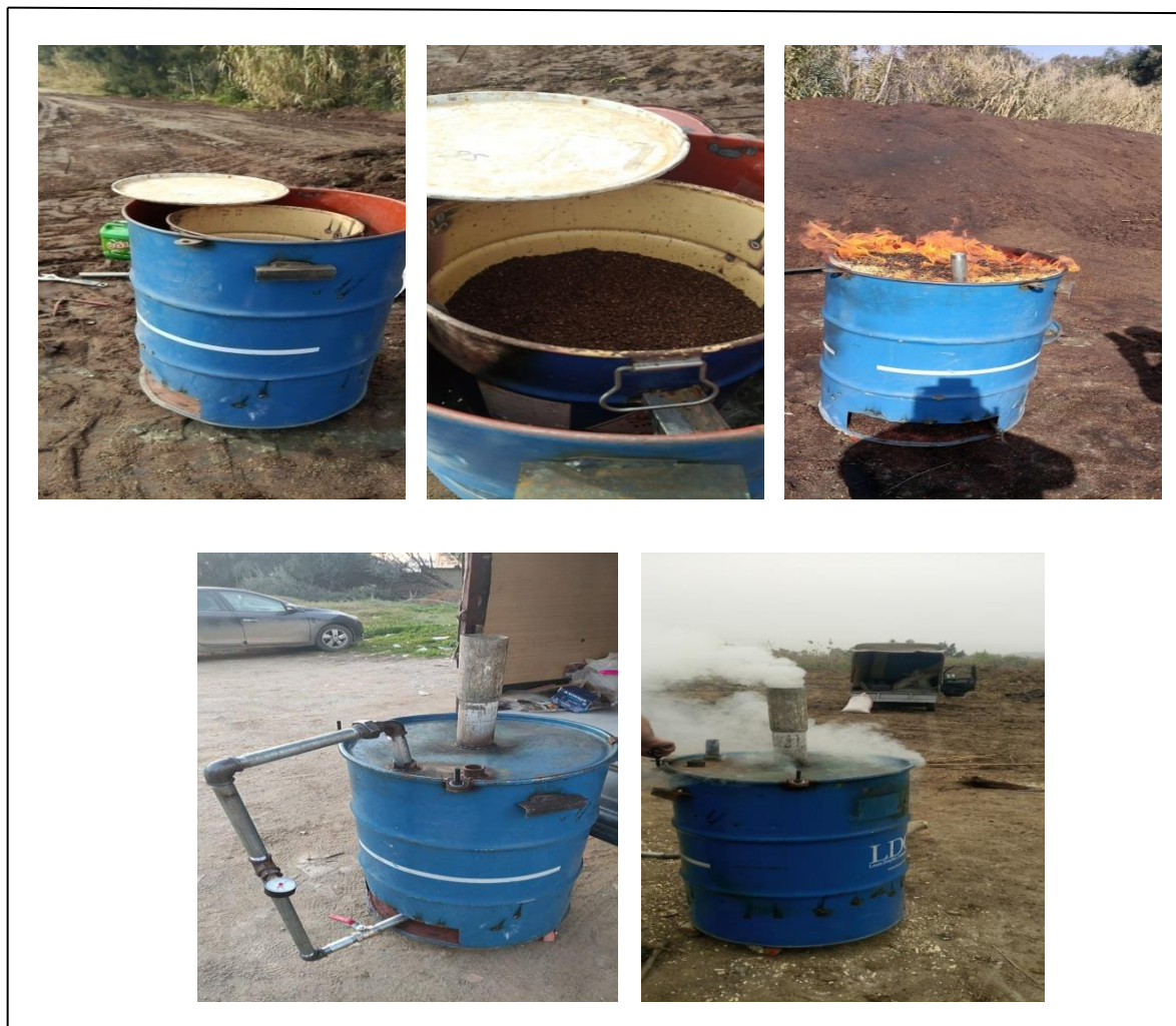
Figure 10 : Étapes de fabrication du biochar [Originale, 2022].
