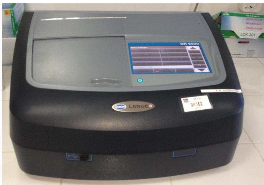
Figure 14 : spectrophotomètres type DR 6000 (HACH LANGE)
