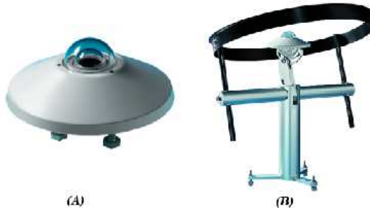
Figure II.04 : Mesure du rayonnement Global (A) et Diffus(B) avec unPyranomètre [34].
