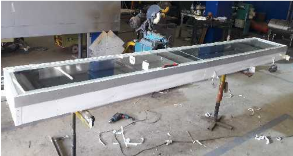
Figure IV.19 : Le récepteur avec sa couverture transparente (vitrage)
