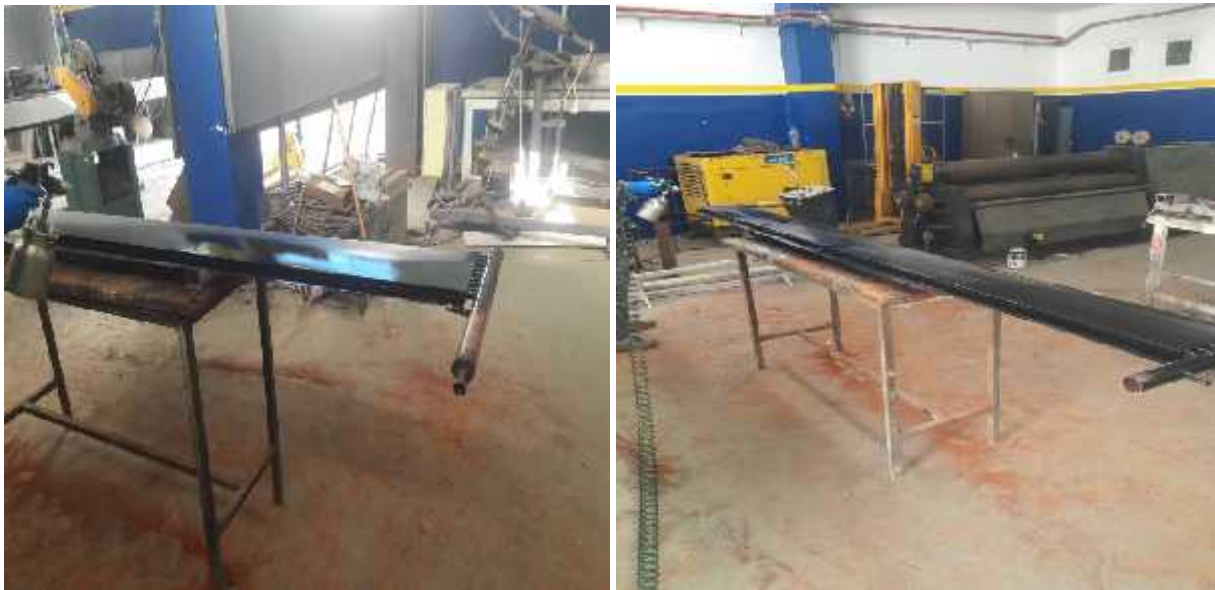
Figure IV.15 : préparation du revêtement sélectif sur les tubes et la plaque
