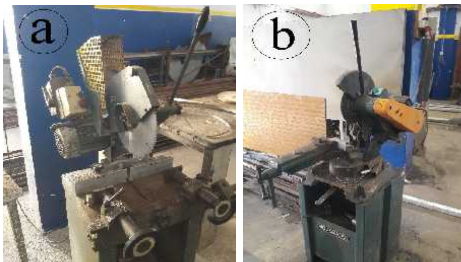
Figure IV.05 : Tronçonneuses (a : pour l'aluminium, b : pour le fer)
