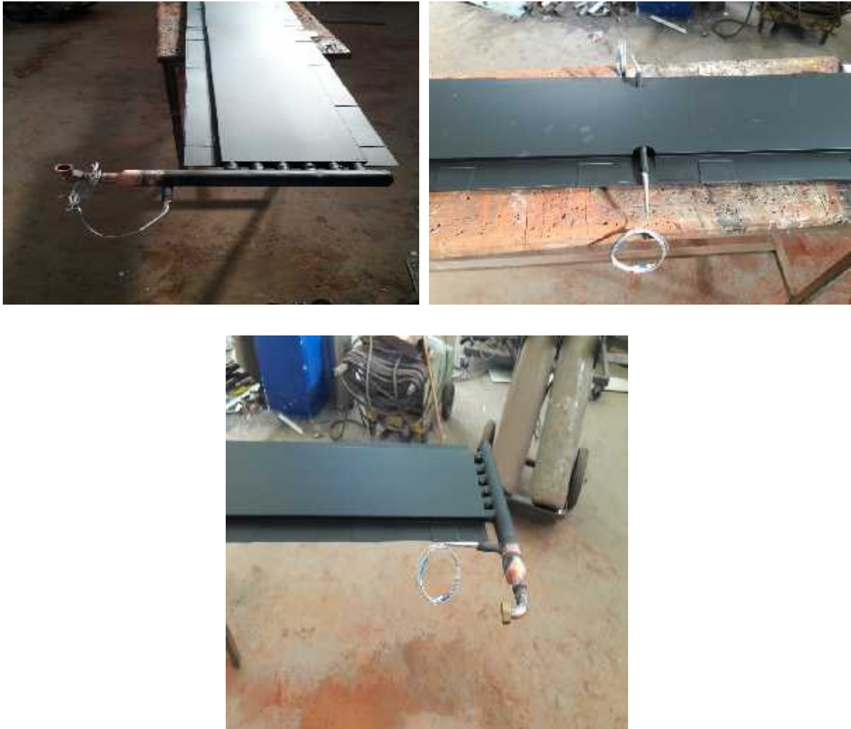
Figure IV.16 : Emplacement des différents thermocouples
