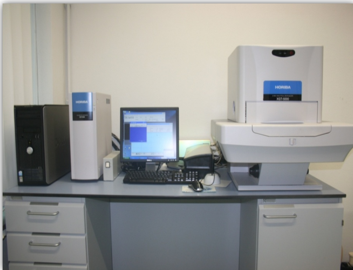
Figure.V.15 : appareil de fluorescence X HORIBA XGT-5000.
