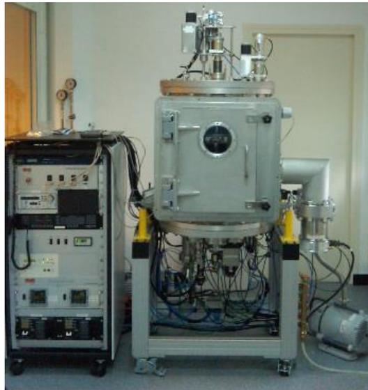
Figure 1.7 Image du bâti d'évaporation d'OLED (avant sa connexion à la boîte à gants) de la Centrale de Proximité en Nanotechnologies de l'Université Paris Nord C(PN)2.
