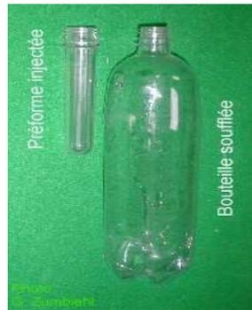
**Figure I.8.** Pièce finale à partir d'un thermoplastique
