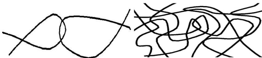
**Figure I.3.** Polymères d'enchevêtrement ( nœud physique) ,( pelote macromoléculaire)
