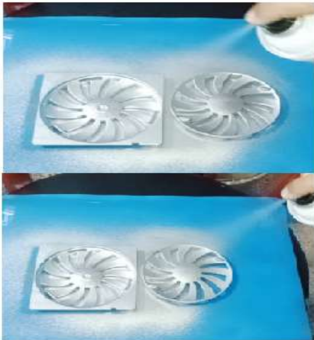
Figure V 18 métallisation de siphon d'évacuation
