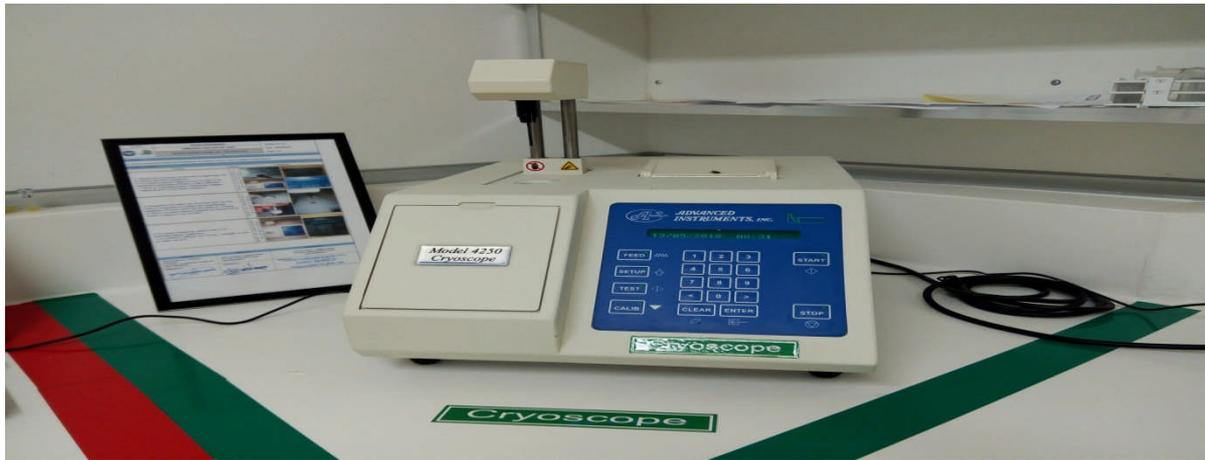
Figure n° 11: Photo d'un cryoscope prise à l'unité de DANONE
