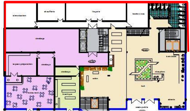
Fig. 103: plan de l'entre sol avec un voile périphérique Source : photo personnelle
