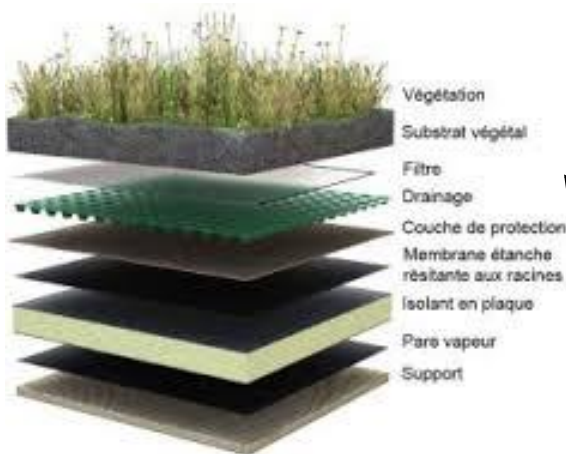
Fig. 127 : détails d'une terrasse végétalisée Source : https://fr.pinterest.com/explore/toiture-v
