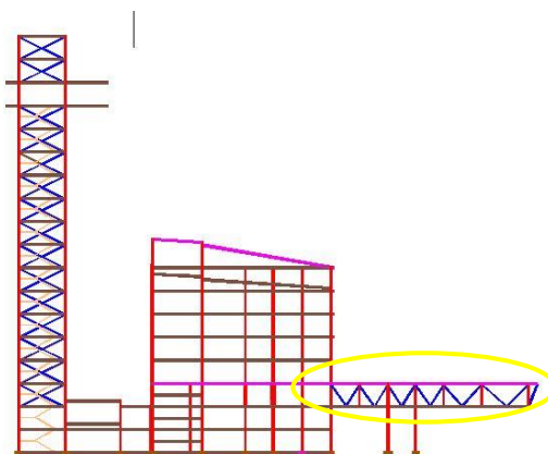
Fig. 119 : Contreventement en V. Source : Auteurs
