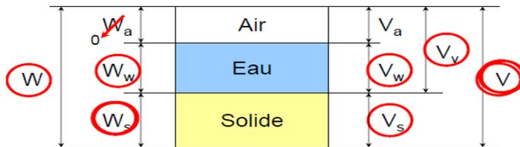
Figure I.2 : Schéma simplifié des trois phases du sol avec des paramètres dimensionnels.
