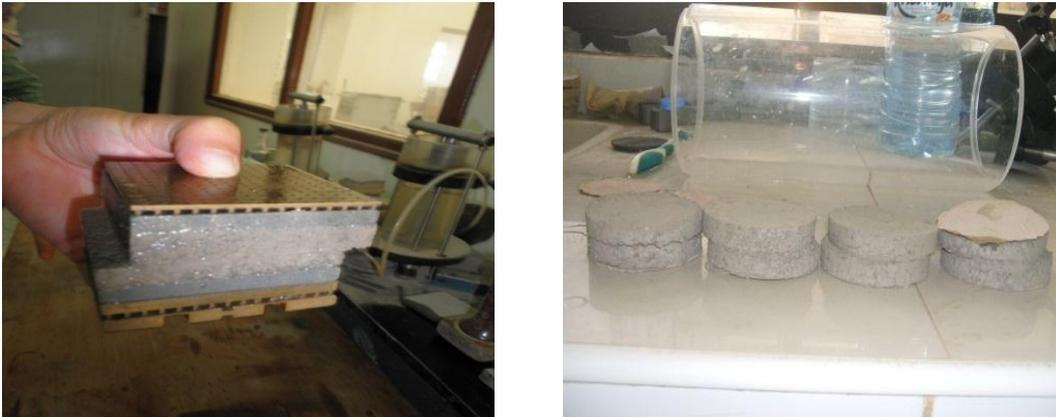
Figure IV.10 : Échantillons après cisaillement.
