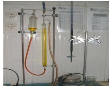
Figure II.27 : Appareil de détermination de  $\text{CaCO}_3$ .
