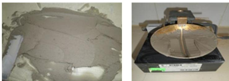
Figure II.17 : Détermination de la limite de liquidité.
