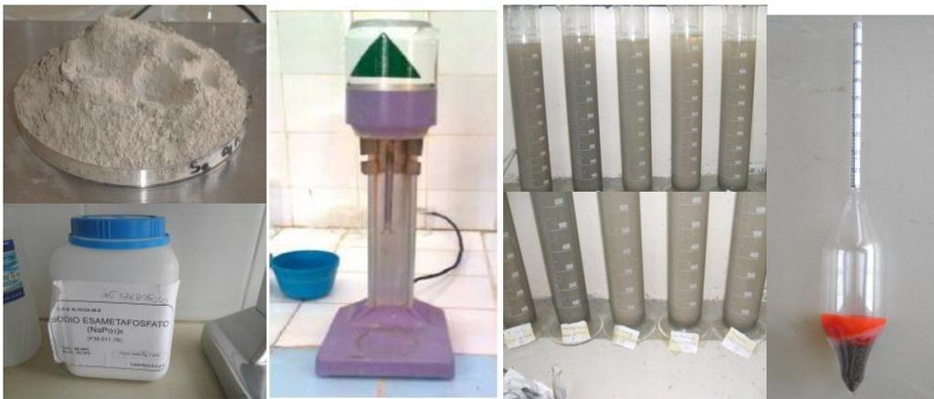
Figure II.9 : Matériel d'essai d'Analyse granulométrique par sédimentométrie
