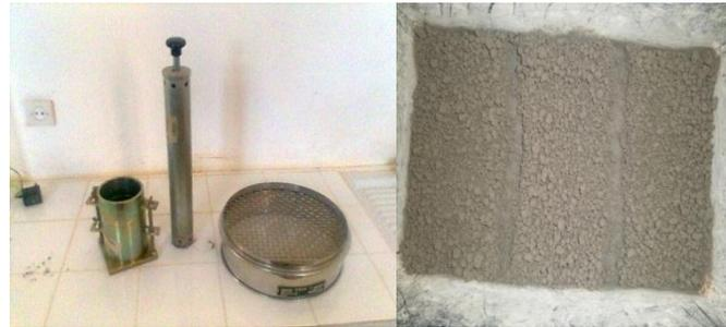
Figure III.3 : Matériel de confection des éprouvettes d'essai Proctor normal.
