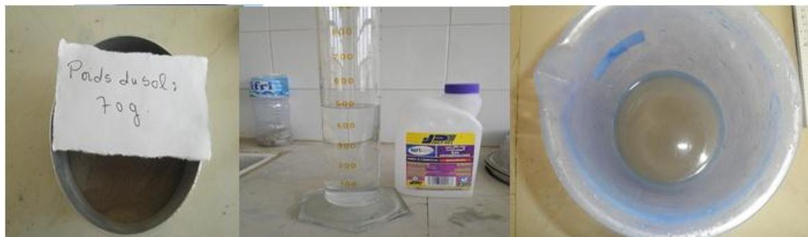
Figure II.25 : Matériel d'essai au bleu de méthylène – Essai à la tâche.
