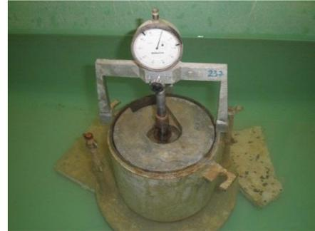
Figure III.12 : Essai CBR, imbibition et gonflement par immersion.
