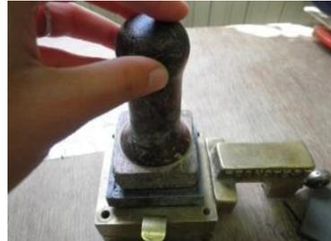
Figure IV.7 : Remplissage et compactage.
