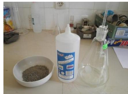
Figure II.4 : Matériel d'essai au pycnomètre.
