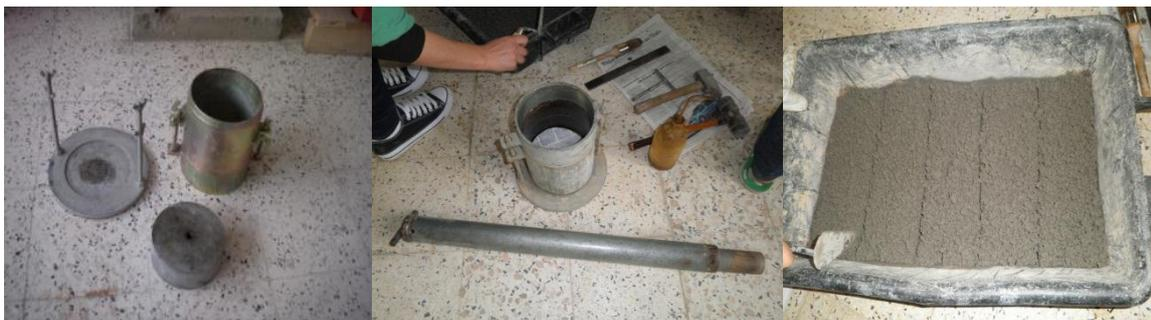
Figure III.13 : Matériel de confection des éprouvettes d'essai CBR.
