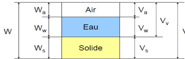
Figure I.1 : Schéma simplifié des trois phases du sol.
