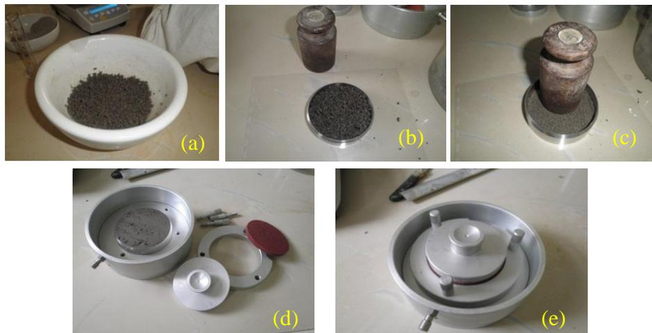
Figure V.3 : Préparation de l'échantillon.
