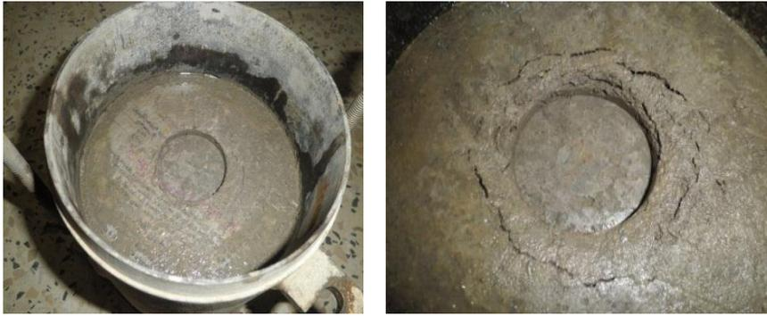
Figure III.16 : Empreinte du poinçonnement.
