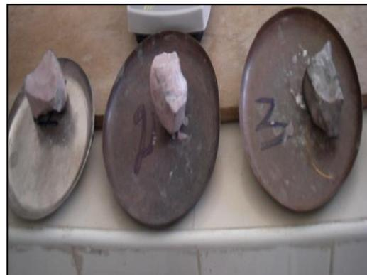
Figure II.6 : Matériel d'essai du poids volumique du sol sec.
