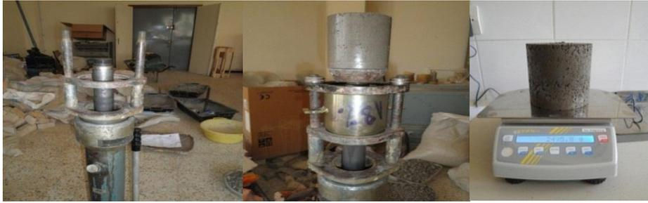
Figure III.4 : Etape de démoulage du moule Proctor.
