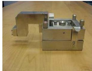
Figure IV.8 : Fixation des deux demi-boîtes.
