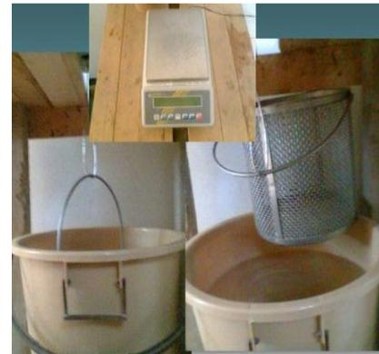
Figure II.5 : Matériel d'essai de l'immersion dans l'eau.
