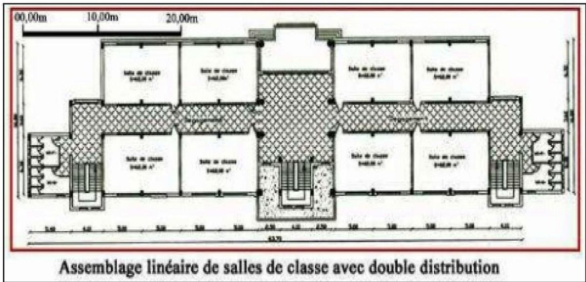
**Figure II.15 :** typologie de plan à corridor central (double distribution).
