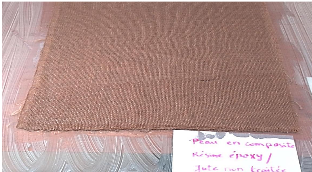
Figure II. 5 : Peau en composite Résine époxy jute non traitée
