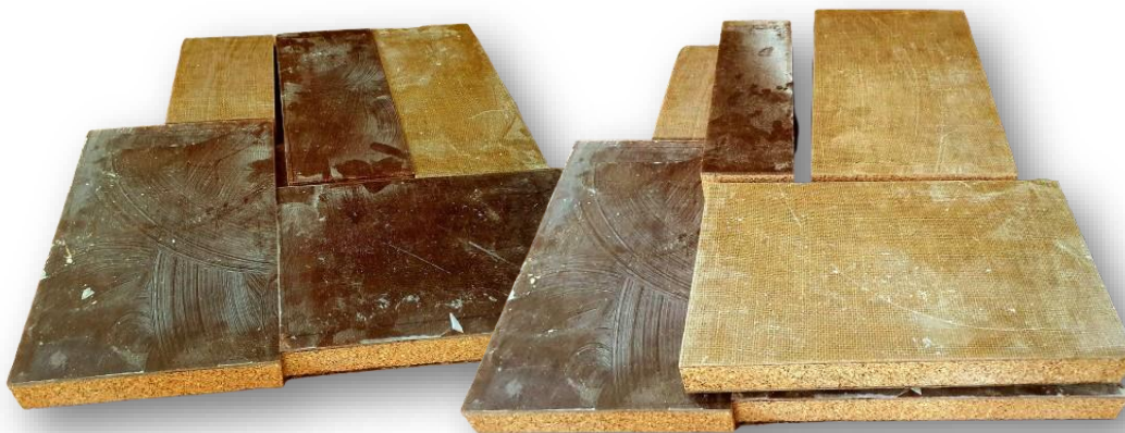
Figure II. 9 : Vue du panneau sandwich après opérations de finition
