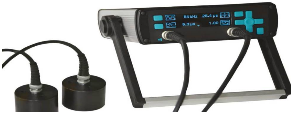
Figure II. 18: Détecteur de défauts par ultrasons utilisé pour la caractérisation acoustique
