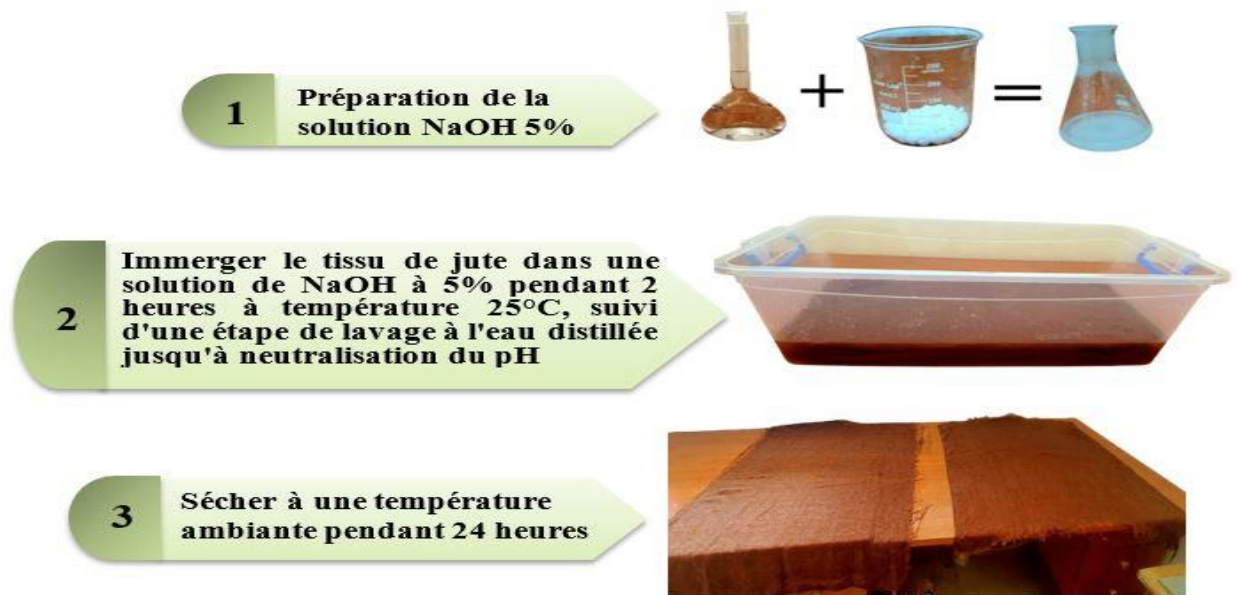
Figure II. 3: Les étapes de traitement alcalin
