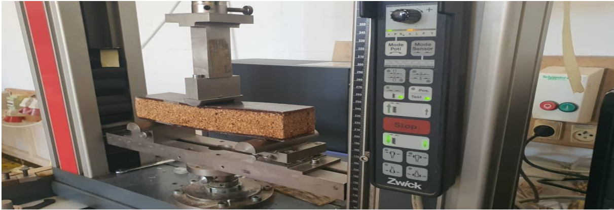
Figure II. 14: Montage d'essai de flexion trois points
