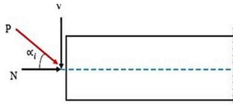
Figure VI. 6: composante de la précontrainte a la section d'about
