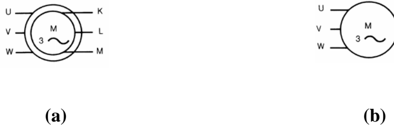
Figure (I.5) : Symbole électrique du moteur asynchrone (a) à rotor bobiné et (b) à cage d'écureuil
