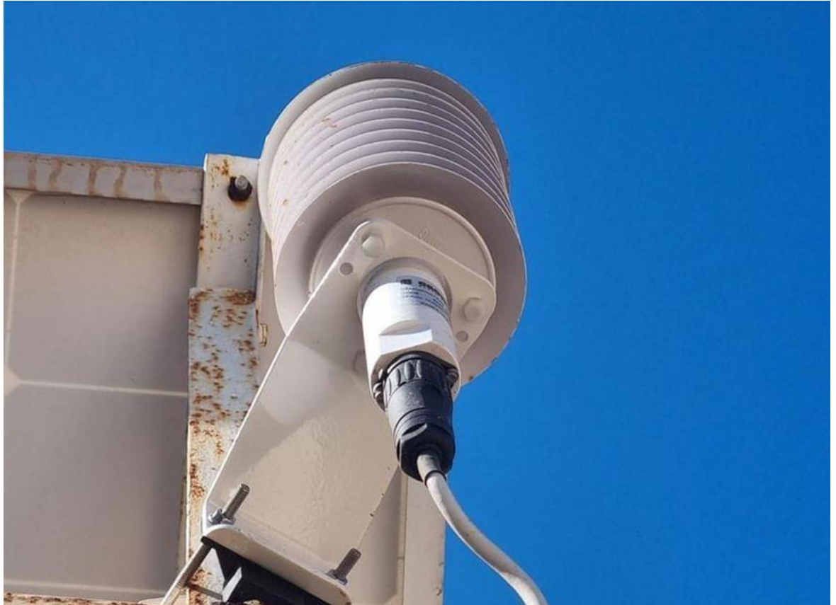
Fig III.10: Image illustrant le capteur de température et d'humidité relative
