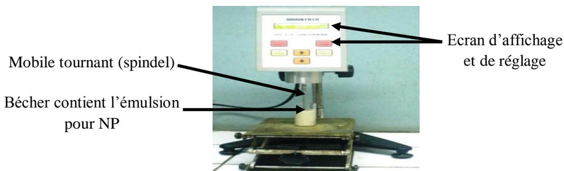
**Figure N° 3** : Viscosimètre à mobile tournant
