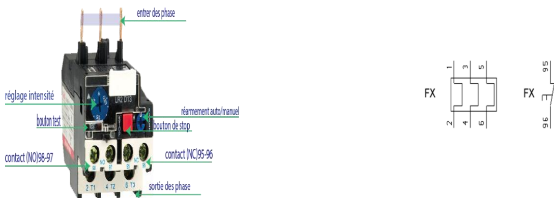
Figure 1.8.2. Relais thermique et son symbole.
