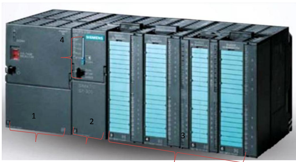
Figure 3.3 API d'un type modulaire (siemens S7)
