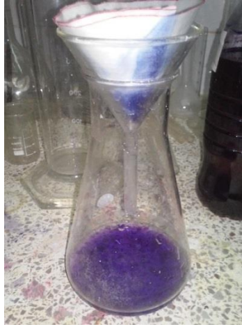
Figure 16 : Filtration du rejet (originale, 2016).
