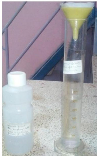
Figure 17 : filtration sur la bentonite (originale, 2016).
