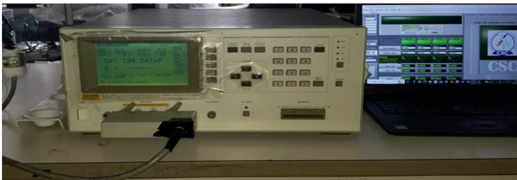
Figure II-6 : Impédance-mètre de type HP 4284A (20Hz-1MHz).
