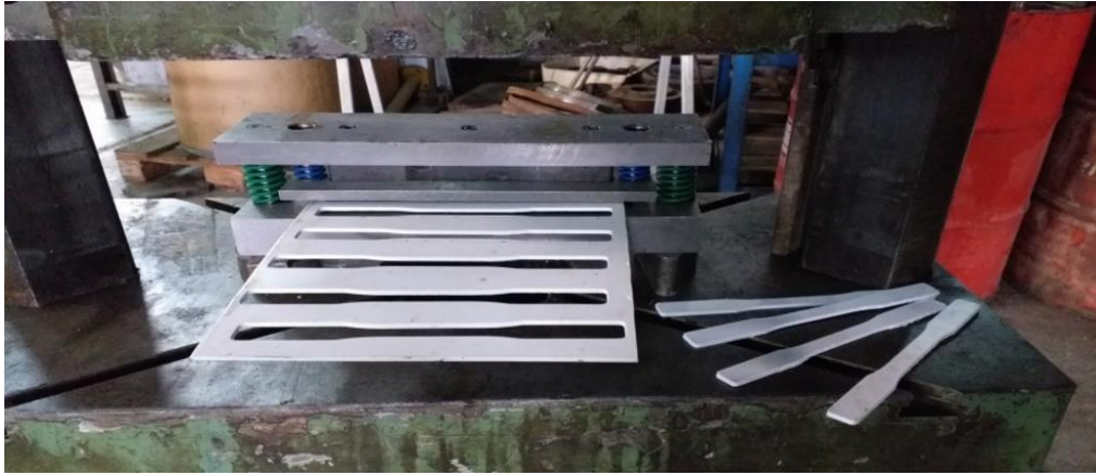
Figure IV-2: Montage poinçon-matrice sur presse (atelier centrale ENIEM).
