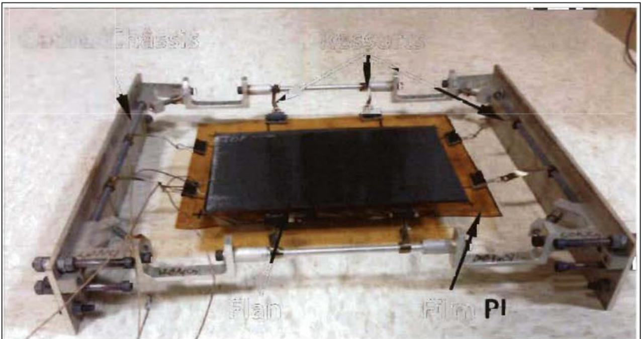
Figure II-15 : Cadre-support avec un flan installé, prêt à être préchauffé.
