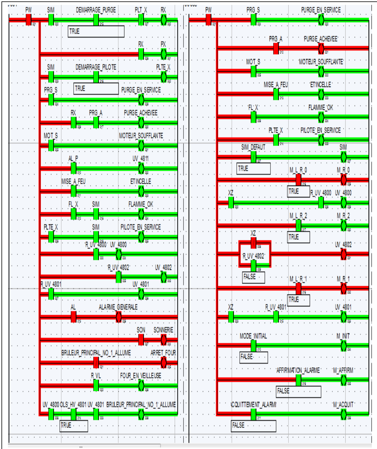
Fig V.18 : Arrêt du four par simulation d'un facteur de déclenchement
