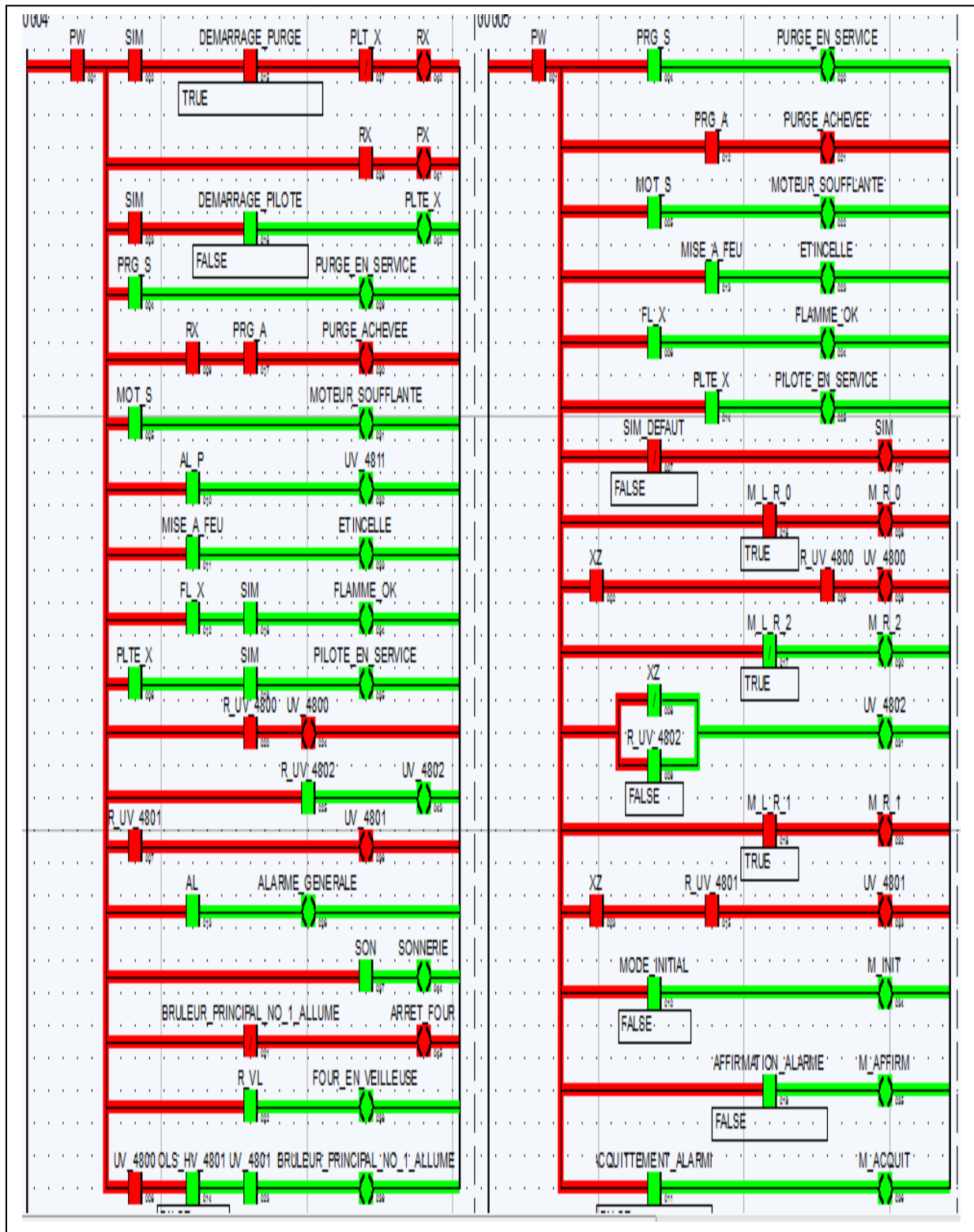
Fig V.15 : Ouverture des vannes du fuel gaz
