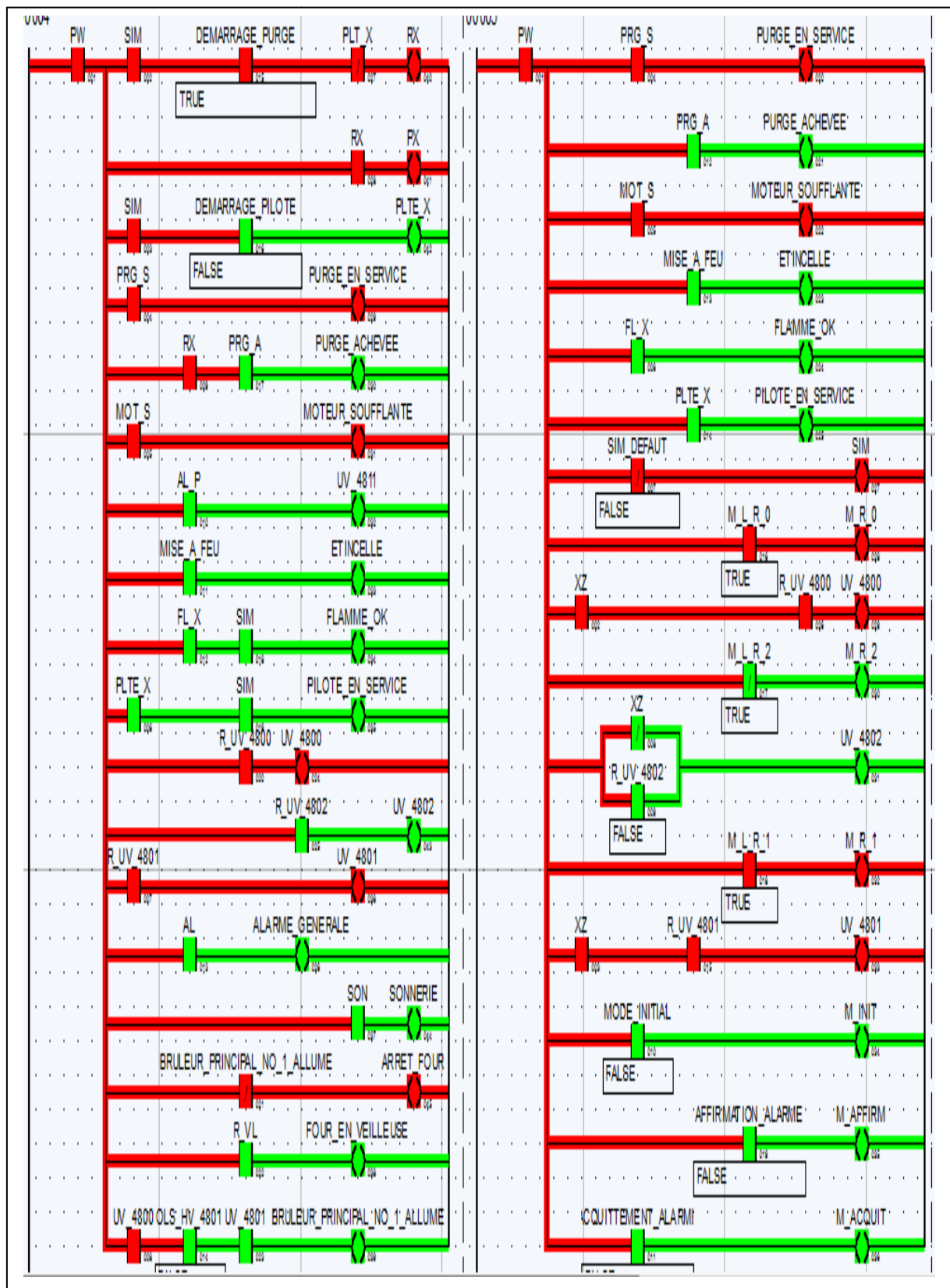
Fig V.13 : Démarrage de la soufflante
