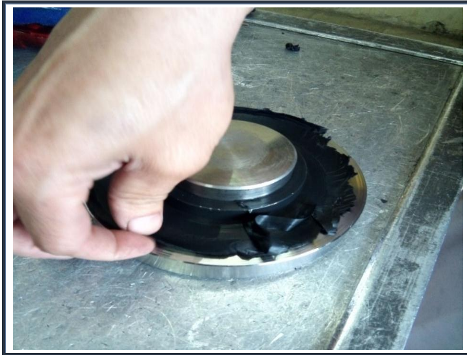
Fig.V.68 : Joint SPI obtenu par la vulcanisation avant ébavurage.
