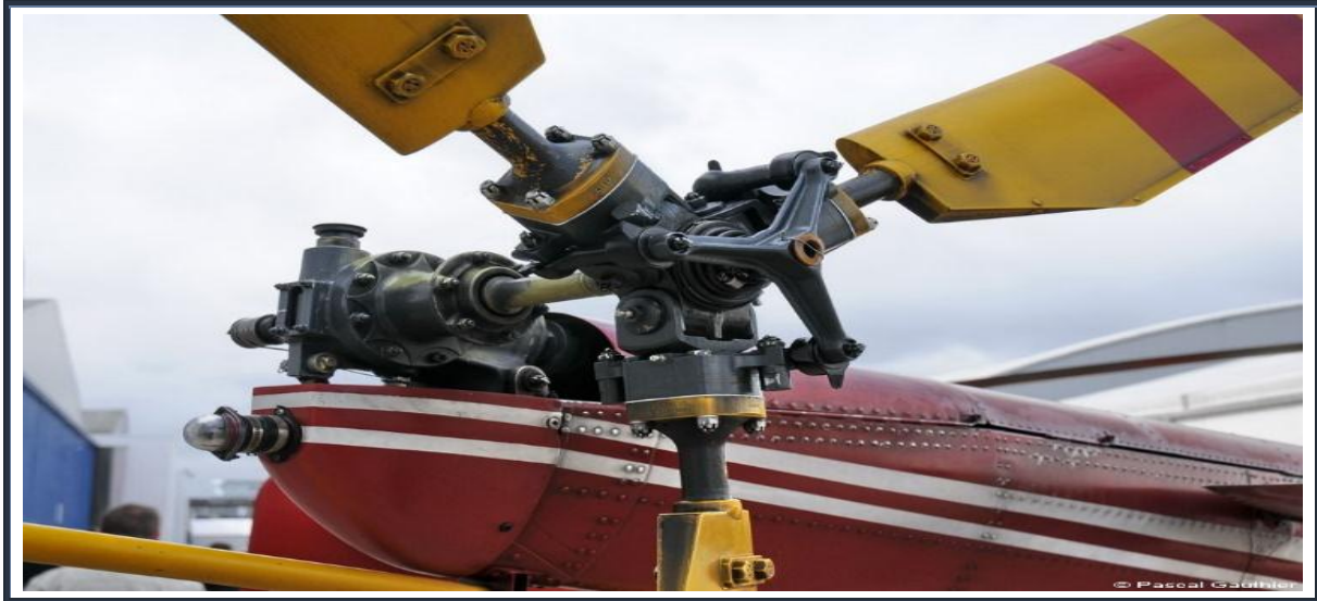
Fig.IV.6 : Rotor anti-couple d'un hélicoptère.
