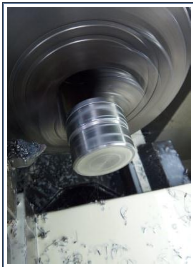
Fig.V.43 : Réalisation du chanfrein du noyau.
