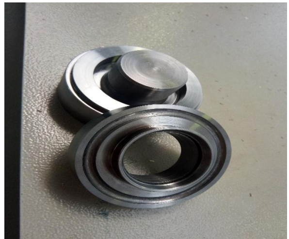
Le moule du petit joint SPI fabriqué et de son armature [10]
