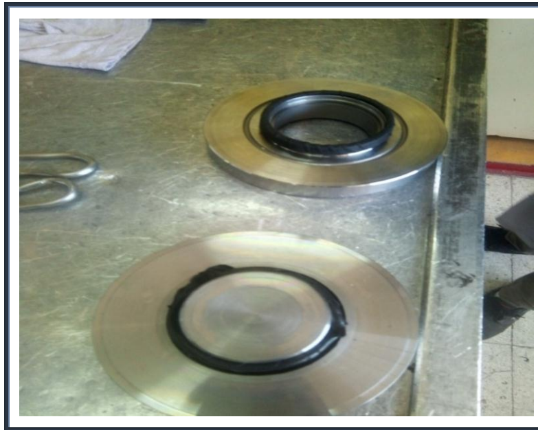
Fig.V.62 : Remplissage de l'empreinte du moule par le bourrage de la gomme.
