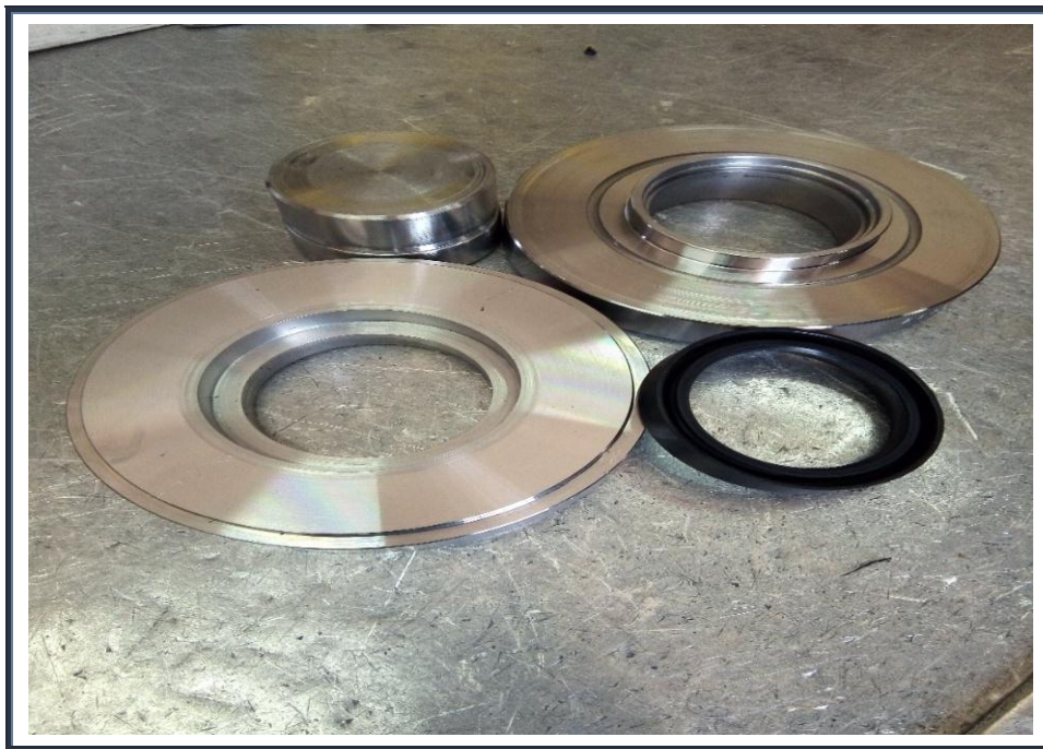
Fig.V.69 : Joint SPI réalisé après ébavurage avec son moule associé.
