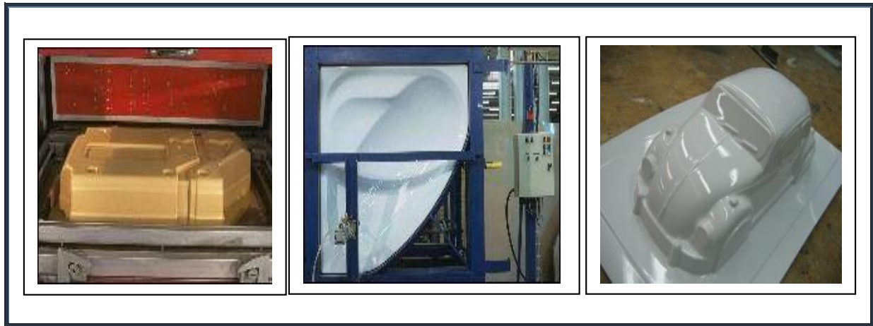
Fig. III.19 : Objets mis en œuvre par thermoformage.
