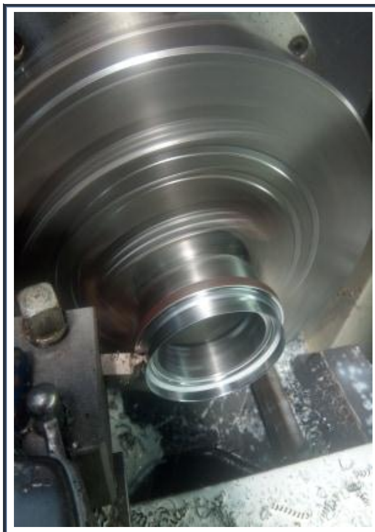
Fig.V.45 : Dressage de l'armature.
