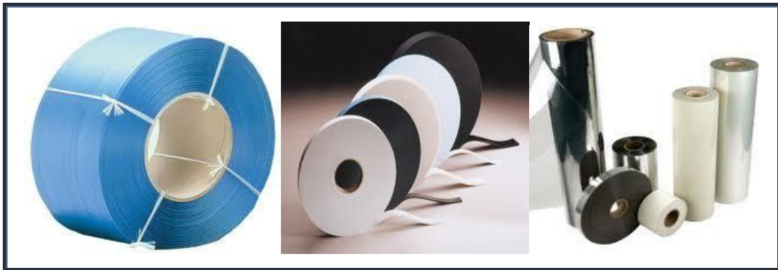
Fig. III.26 : Articles mis en œuvre par calandrage.
