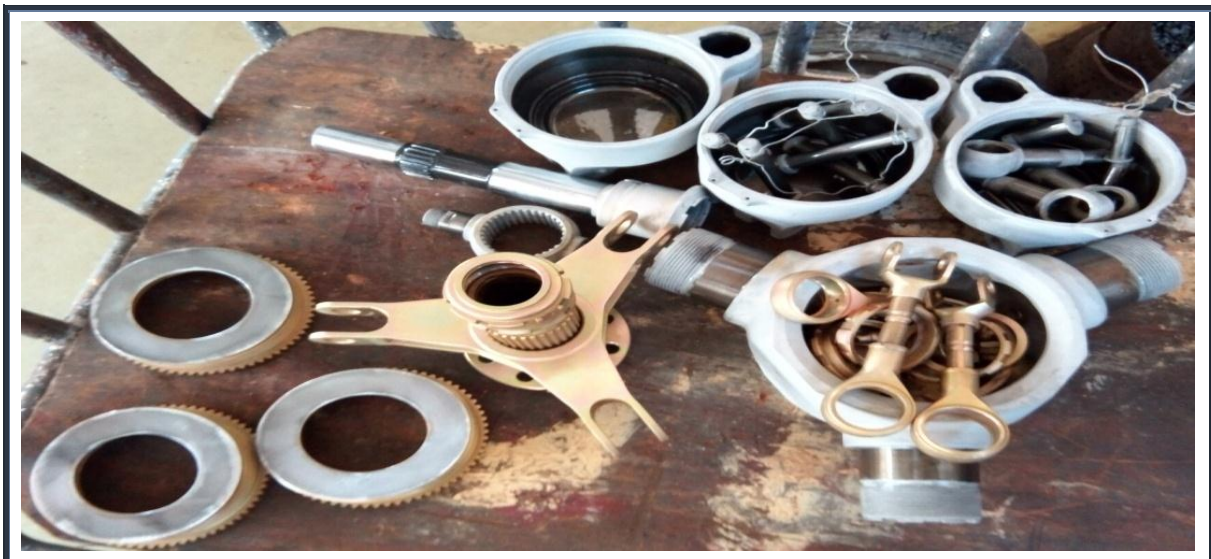
Fig.IV.7 : Rotor anti-couple décomposé (réel).
