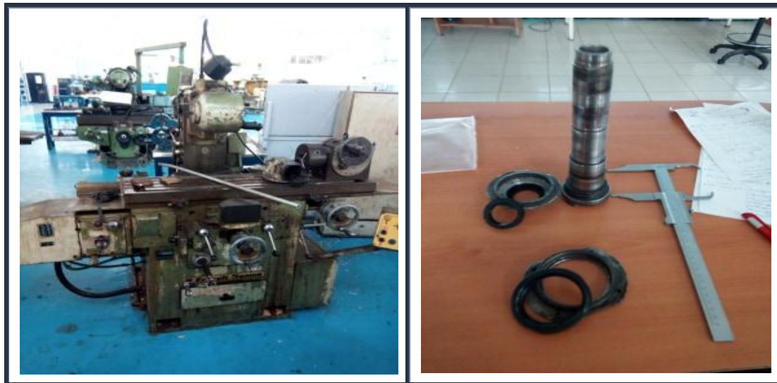
Fig. V.1 : Détérioration des deux joints SPI se trouvant dans les deux logements séparés de l'arbre de la broche au niveau de la fraiseuse.
