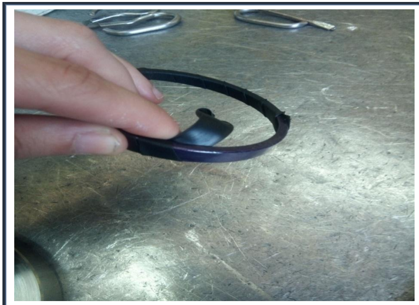
Fig.V.61 : Enrobage de la gomme sur l'armature.
