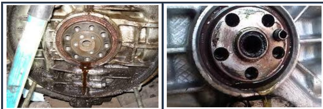
Fig. II.32 : Fuite du joint.
