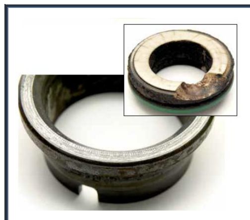
Fig. II.13 : Des fissures thermiques.
