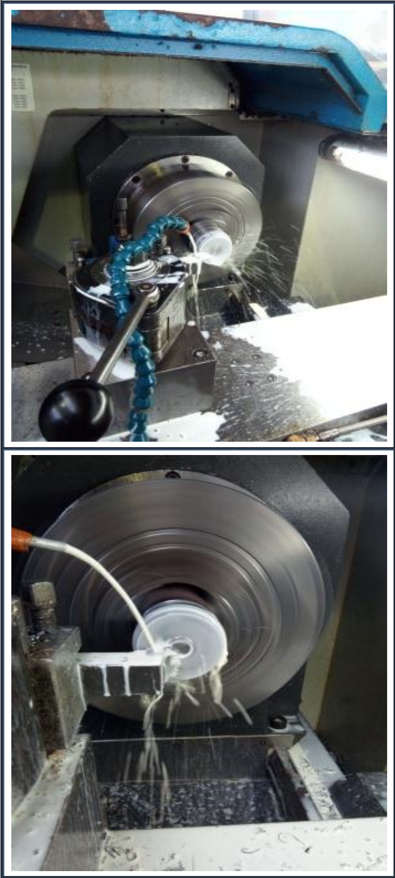
Fig.V.38 : Chariotage et dressage du noyau.
