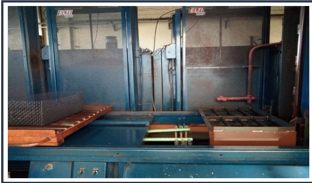
Fig.V.74 : Four et bain d'huile pour le traitement thermique.
