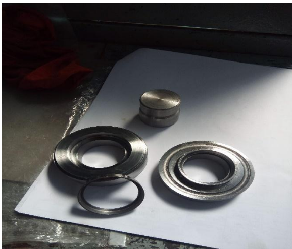
Le moule du petit joint SPI fabriqué et de son armature [10]
