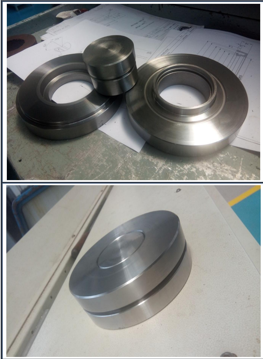
Fig.V.50 : Le moule obtenu pour le grand joint SPI de la fraiseuse.
