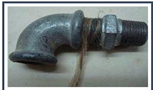
Fig. II.5: Joint de tuyauterie.
