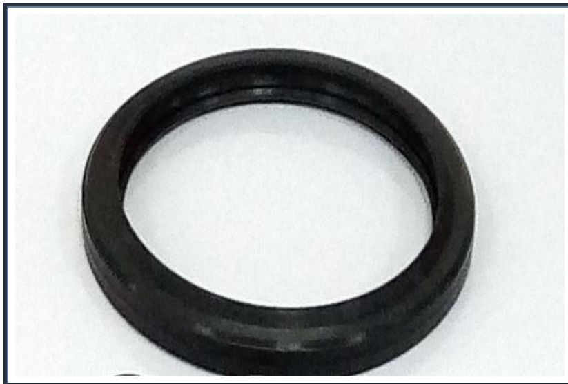
Fig.IV.28 : Joint obtenu après le moulage par compression.
