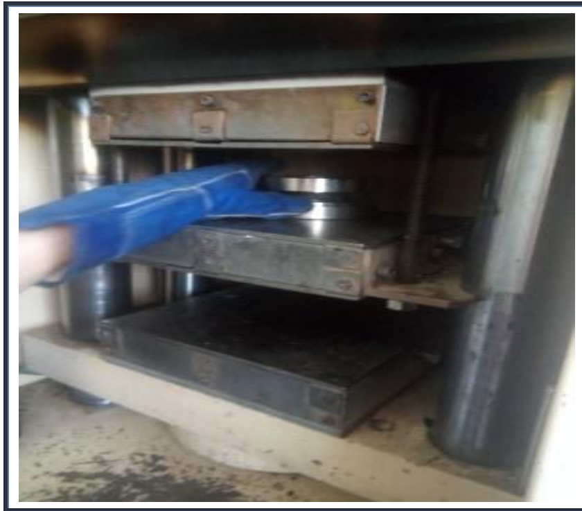
Fig.V.66 : L'extraction du moule.
