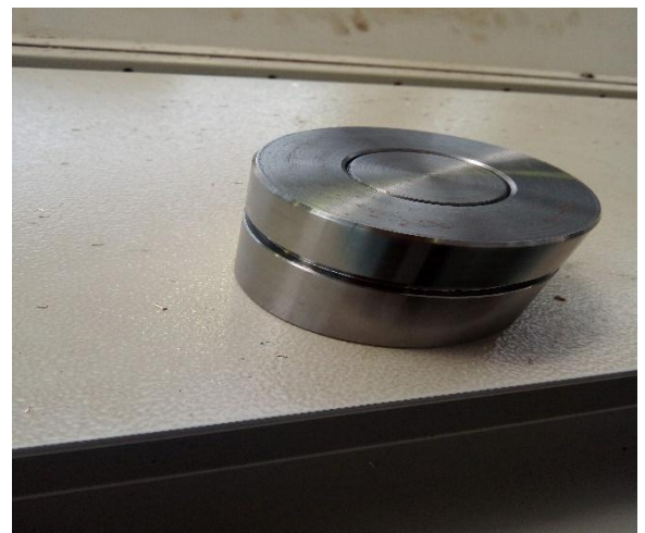
Le moule du petit joint SPI fabriqué [11]
