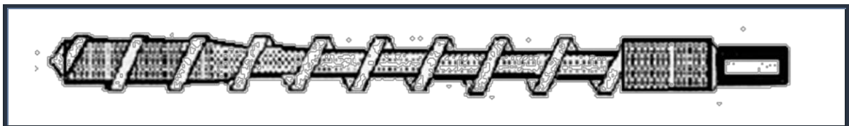
Fig. III.13 : Vis pour matière amorphe.
