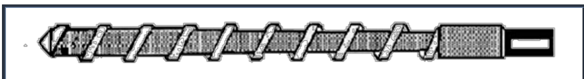
Fig. III.14 : Vis pour matière semi cristalline.
