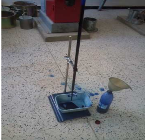
Figure -III.14 - : Le dispositif de dosage.
