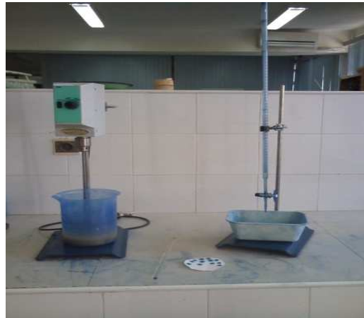
Figure -III.12- : L'essai au bleu de méthylène.
