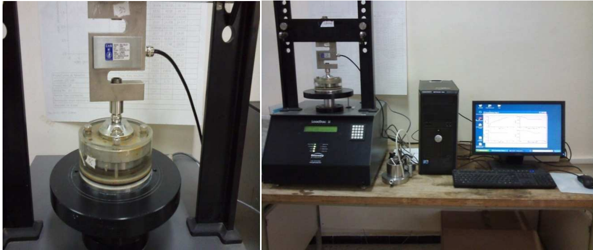
Figure -V.29- : L'essai œdométrique.
