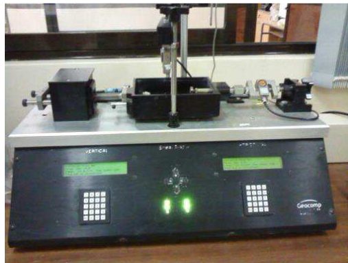
Figure -V.9- : L'appareil de cisaillement.
