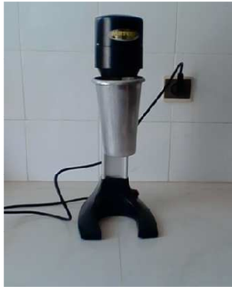
Figure -II.3- : L'agitateur mécanique.
