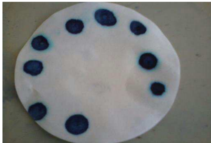
Figure -III.18 - : Le test de la tache.
