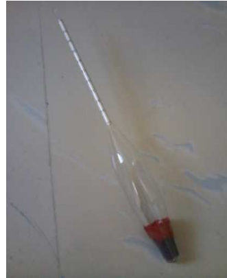
Figure -II.4- : Le densimètre.
