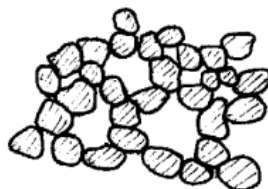
Figure -I.7- : La structure en nid d'abeilles.
