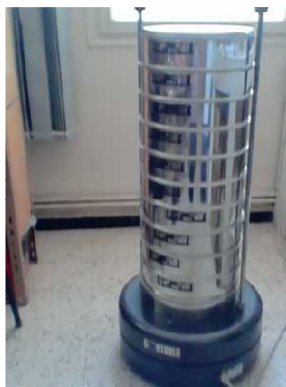
Figure –II.1- : L'appareillage spécifique au tamisage.
