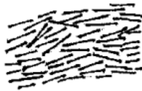
Figure -I.10- : La structure dispersée.
