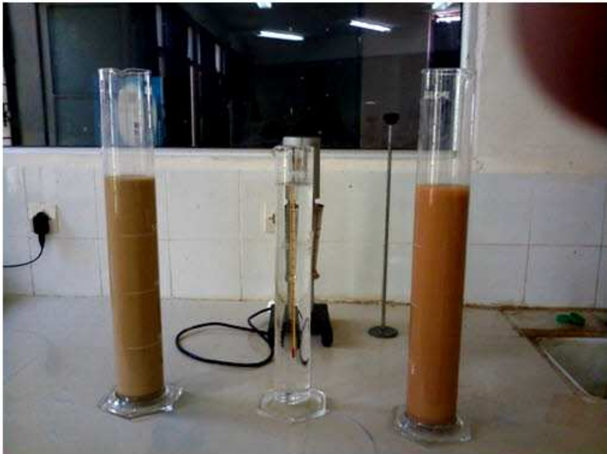
Figure -II.5- : L'essai de sédimentation.
