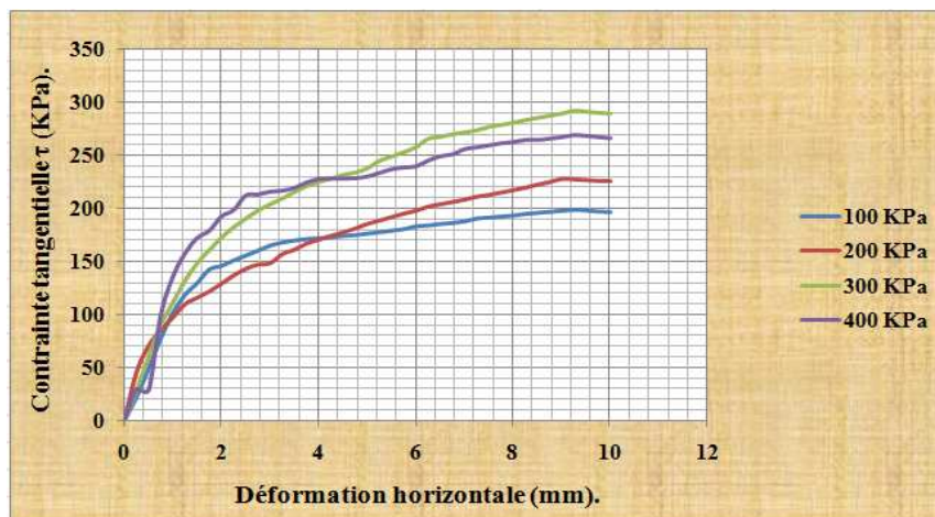
Figure -10- : La courbe contrainte-déformation pour le puits P60 (0,60 / 1,20) m.
