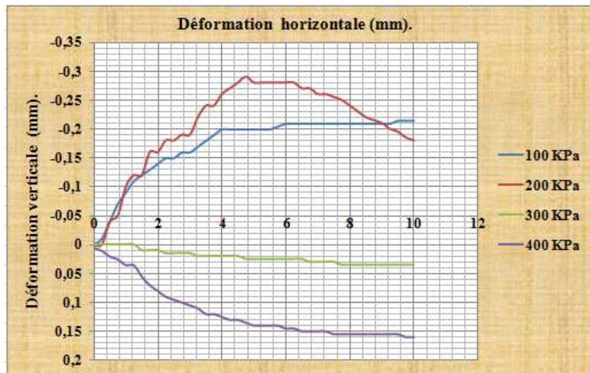
Figure -29- : La courbe de la variation de volume pour le puits P67 (0,50 / 0,80) m.
