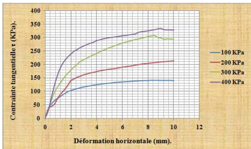
Figure -7- : La courbe contrainte-déformation pour le puits P52 (0,50 / 0,80) m.
