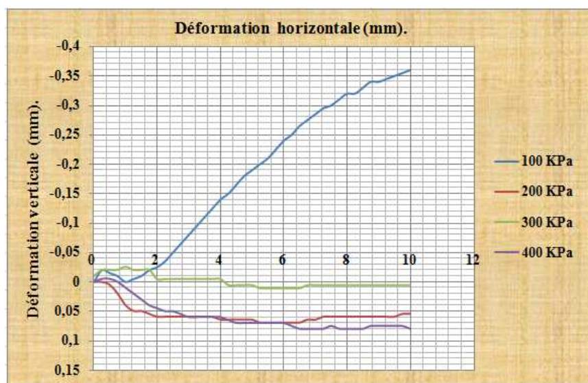
Figure -22- : La courbe de la variation de volume pour le puits P50 (1,00 / 1,30) m.
