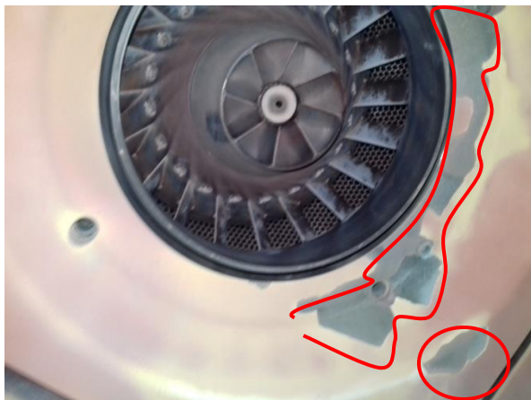
Arrachement du revêtement, fissures Légères et décoloration
