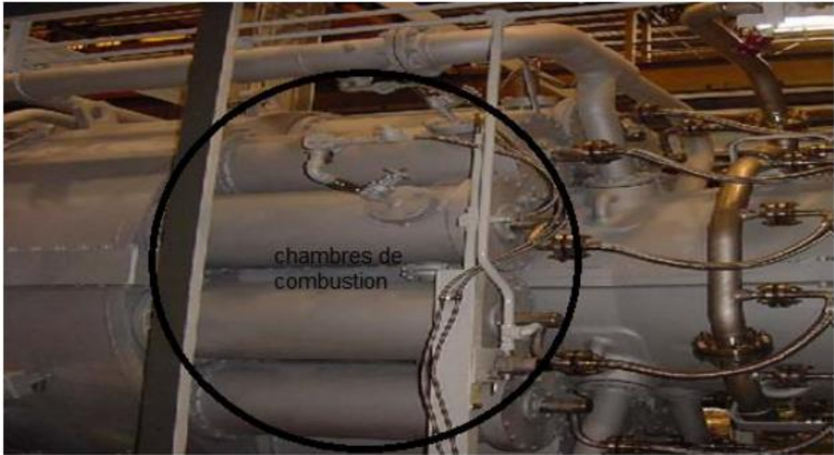
Figure II.4 : La chambre de combustion
