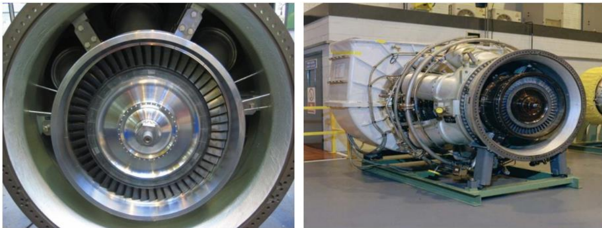
Figure II.7 : Caisse turbine du compresseur (HP)
