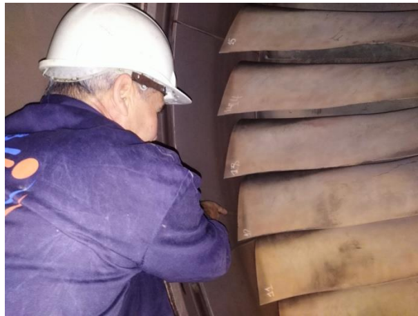
Figure IV.17 : Vue sur inspection dans les ailettes du 4 ème étage.
