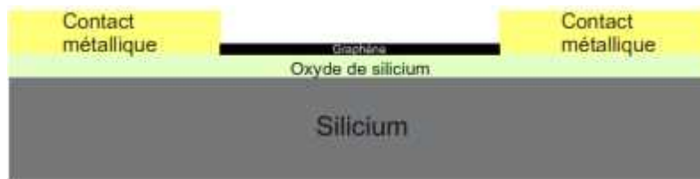
Figure II.5 : Schéma d'une structure « pseudo MOS ». Le substrat silicium dopé sert de grille de transistor.
