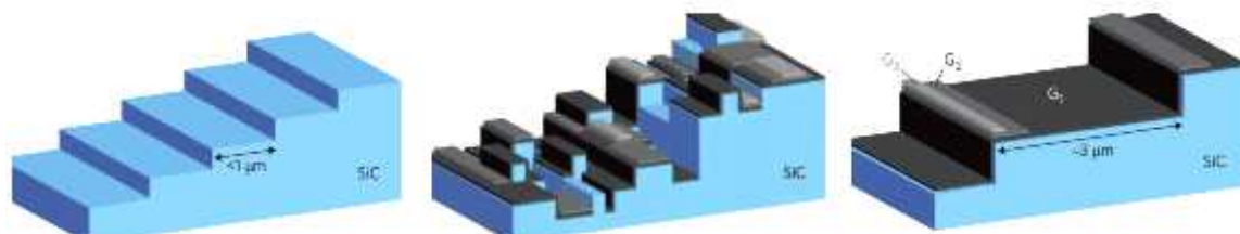
Figure II.13 : Schémas représentant un substrat de SiC (face Si) après gravure à l'hydrogène (a) et après graphitisation sous UHV (b) ou sous argon (c). Dans le dernier cas, la surface est non déstructurée, et le film de graphène est continu. [9].
