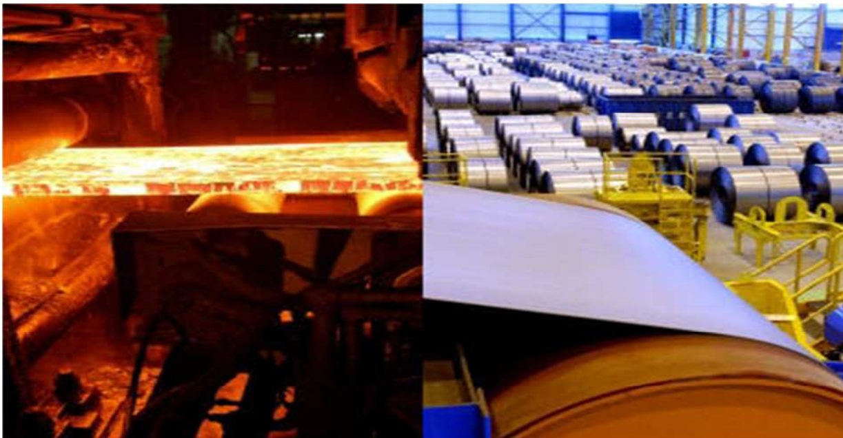
Fig 3-1 : Laminage à chaud à Bizkaia, en Espagne et laminage à froid à Vega do Sul, au Brésil La classification des produits
