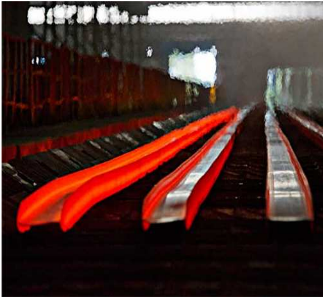
Fig 4-I : Laminage à chaud (poutrelle)
