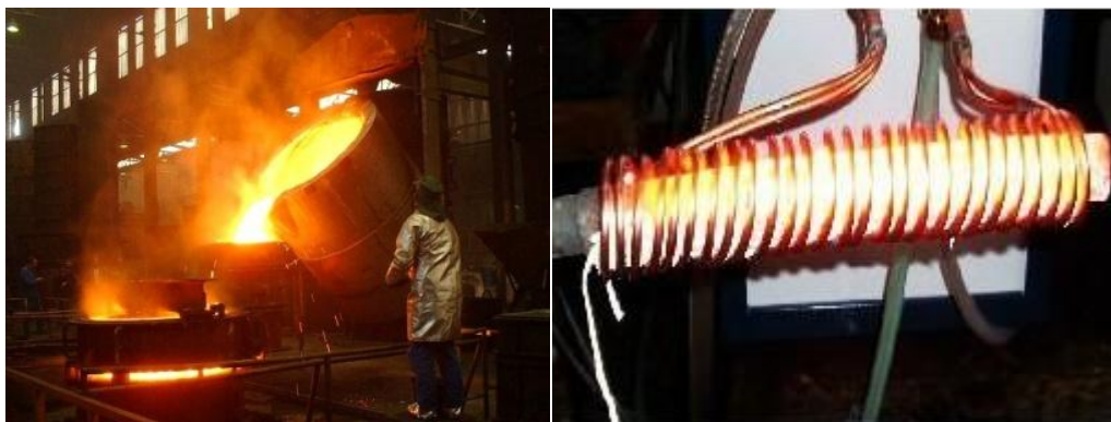
Figure I.2 : chauffage par induction de métaux
