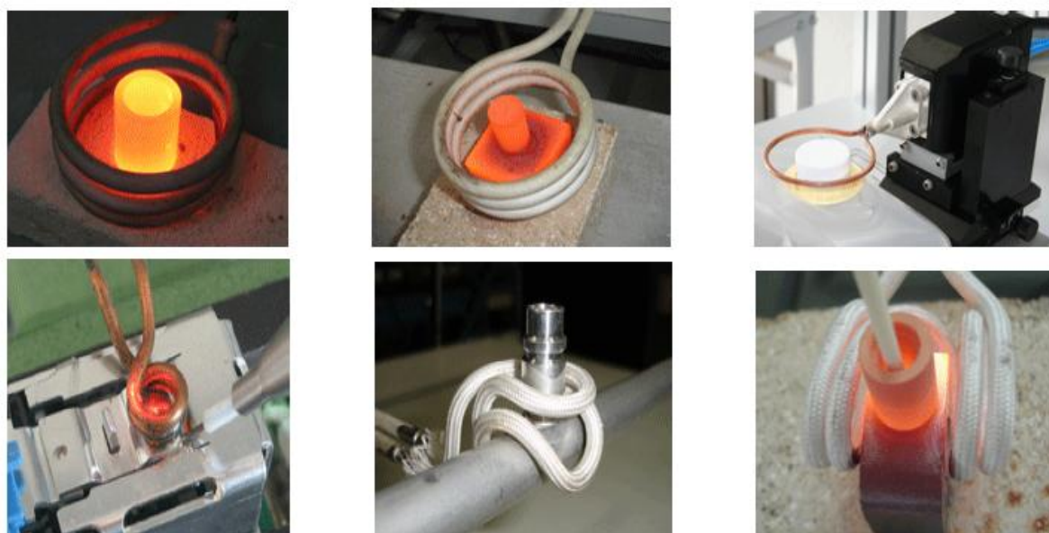
Fig I.3: chauffage avec des inducteurs différents
