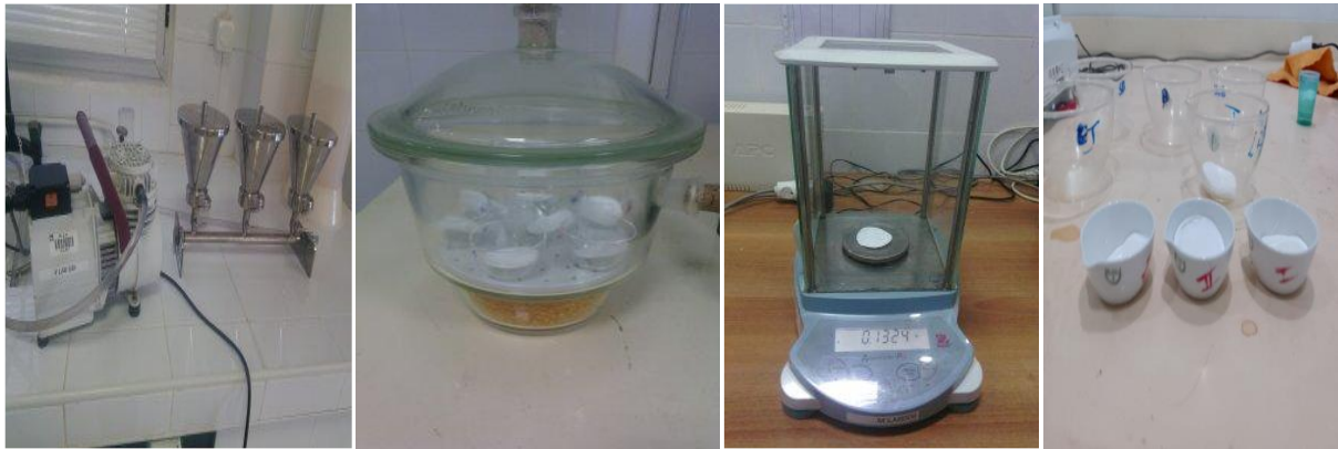
Fig. 13 : Appareil et matériel utilisés pour les MES.
