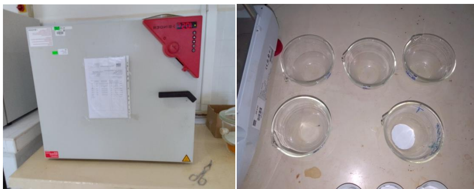
Fig. 14: matériel et appareil pour les résidus secs.
