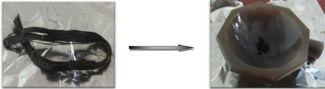
Figure III-3- Les fibres de carbone avant et après broyage
