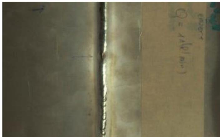
**Figure. III.3.** Photographie de la tôle soudée de l'alliage Ti-6Al-4V
