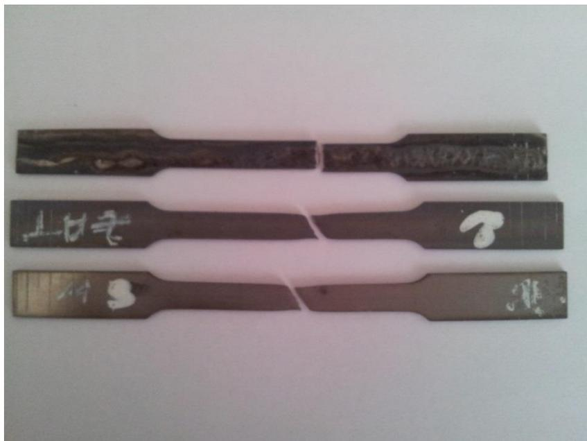
Figure. III.14. Epreuve après essai de traction des trois zones du cordon de soudure
