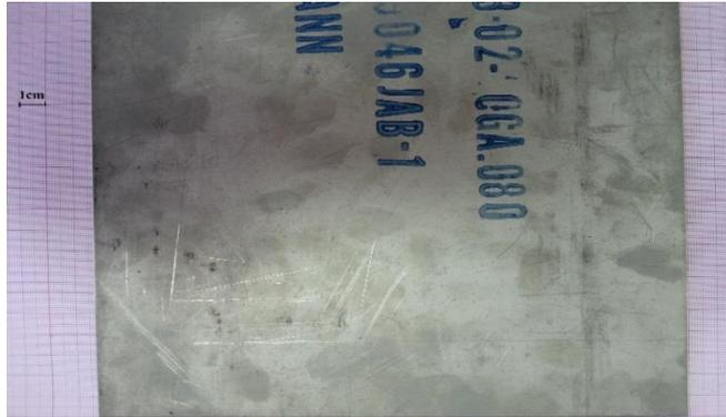
**Figure. II.1.** Photographie de la tôle de l'alliage Ti-6Al-4V (% en poids) à l'état reçu.
