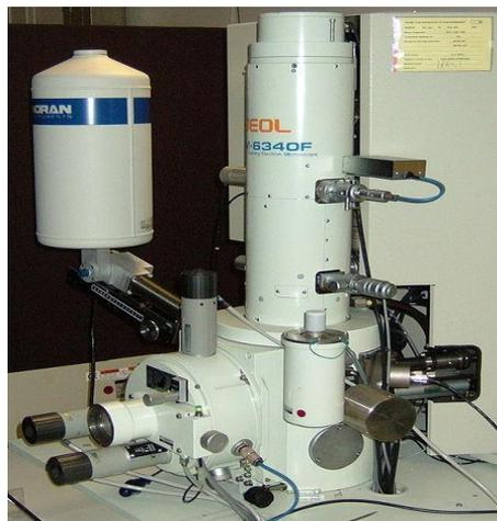
**Figure. II.2.** Microscope électronique a balayage
