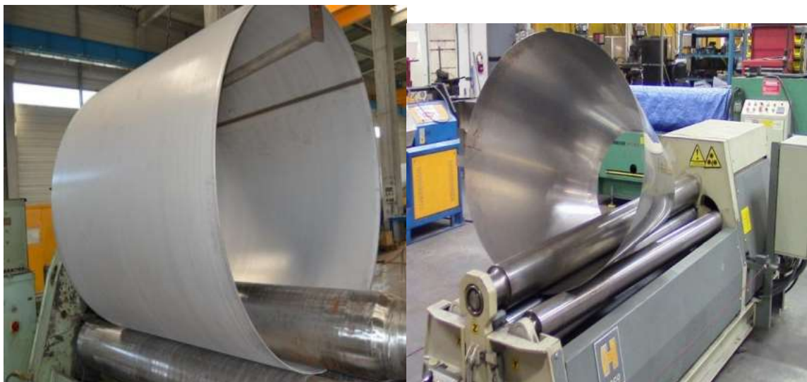
Figure 12 : roulage cylindrique et conique
