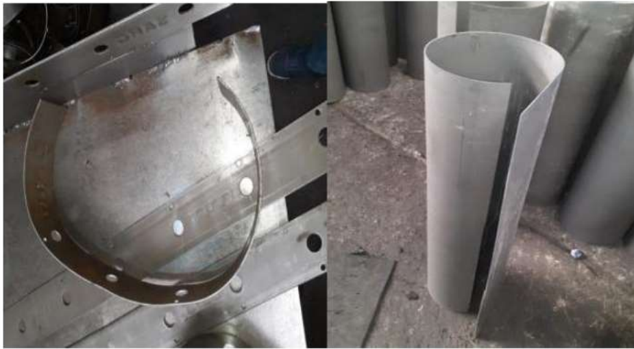
Figure 35: Défauts de réglage de mouvement
