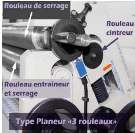
Figure 20 : roulage de type planeur
