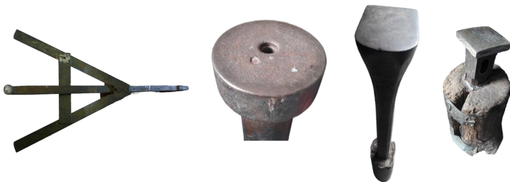
صورة رقم 03 تبين أنواع السندان (الزبرة) المتواجدة لدى الحرفيين
