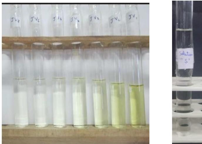
Figure 58: Solution de caféine et la gamme étalon jaune-verte
