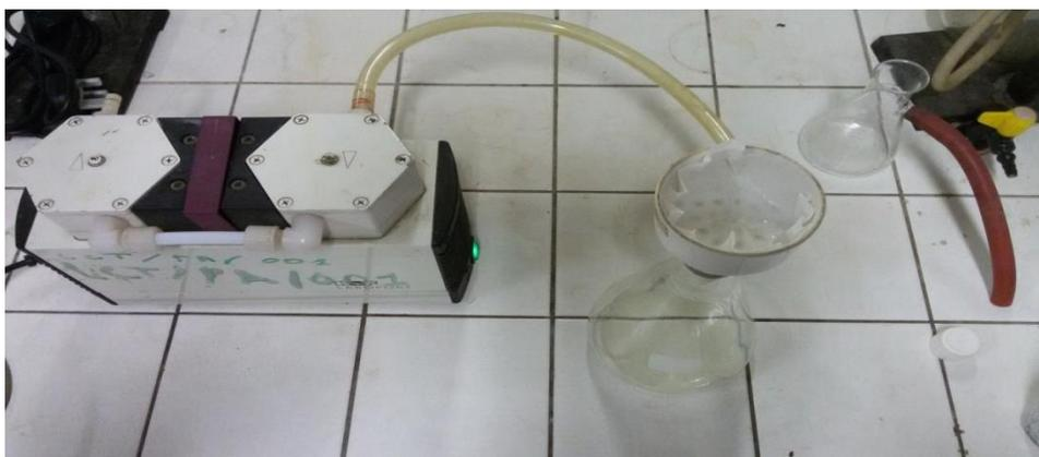
Figure 23: Montage de la filtration sous vide.
