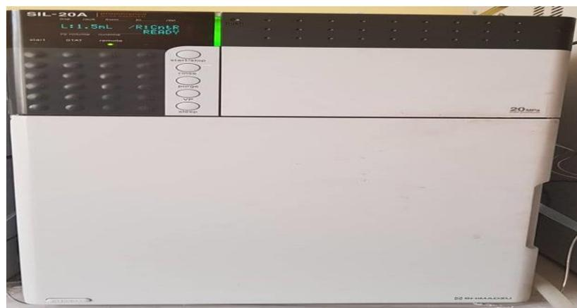
Figure 32 : Pompe d'injection de l'HPLC SHIMADZU
