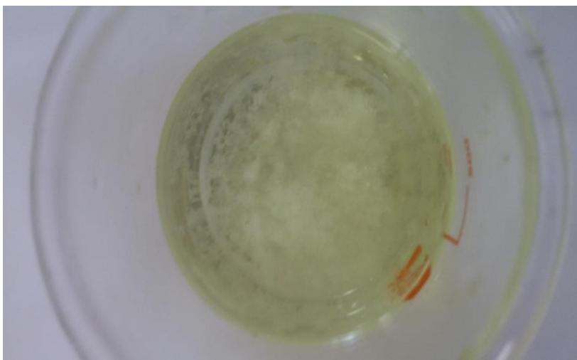
Figure17 : Séchage par le chlorure de calcium
