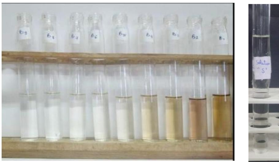
Figure 55 : Solution de caféine et la gamme étalon brune.
