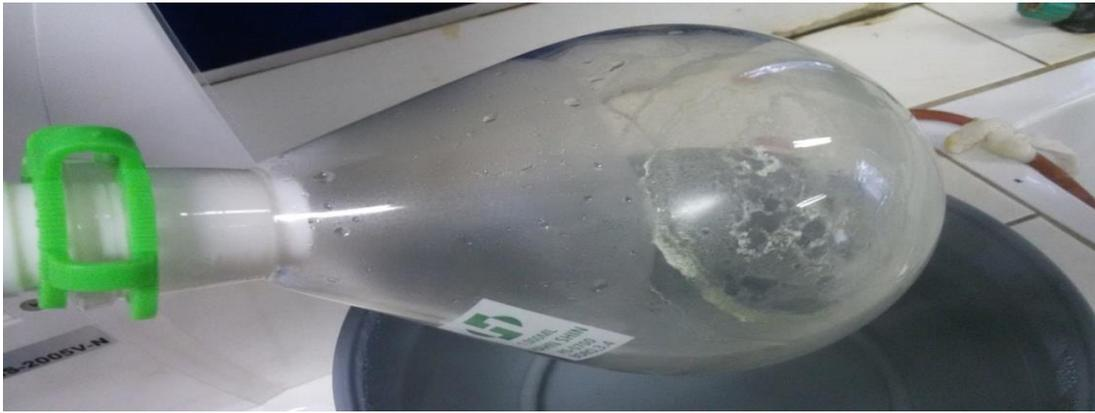
Figure19 : Caféine récupérée après distillation au rotarvapeur.
