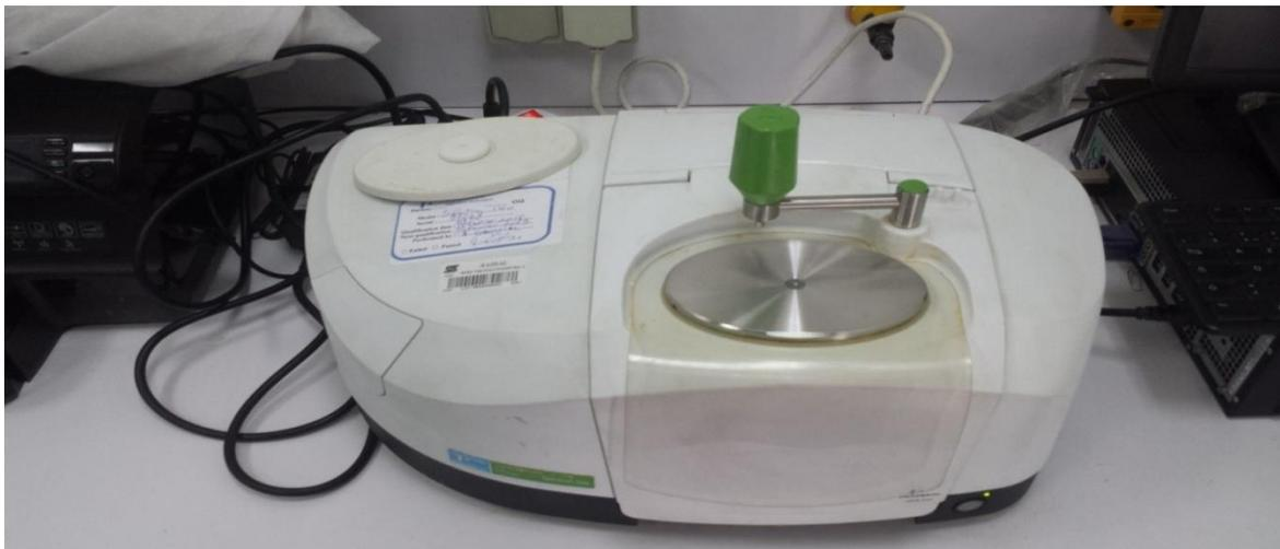
Figure28 : Spectrophotomètre infrarouge PerkinElmer SPECTRUM TWO
