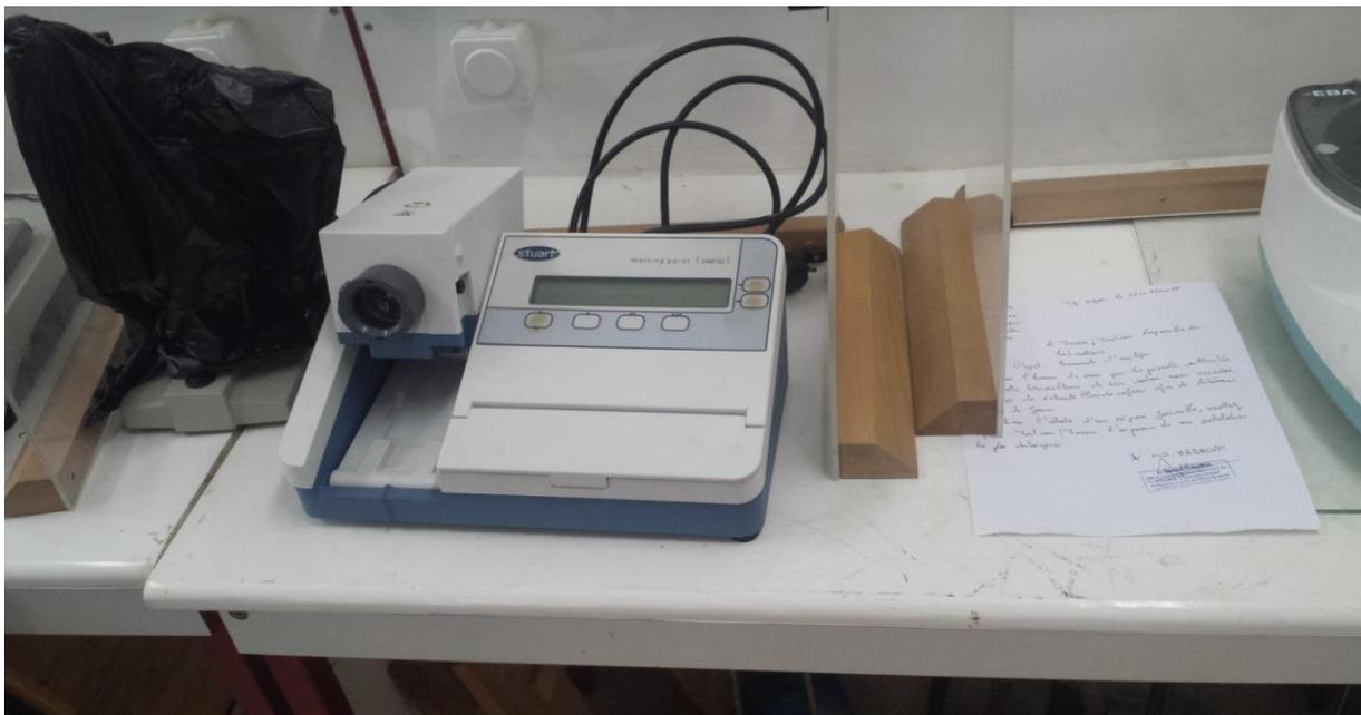
Figure 30 : Appareil de point de fusion Stuart
