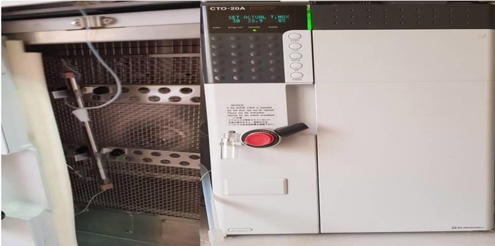
Figure 33 : Colonne C18 de l'HPLC SHIMADZU
