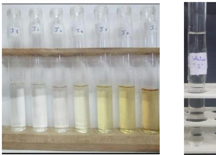
Figure 57: Solution de caféine et la gamme étalon jaune
