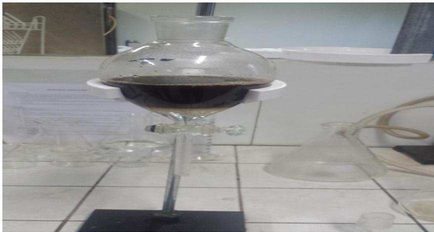
Figure15: Décantation du mélange réactionnel
