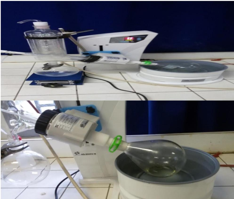
Figure 18: Distillation de la phase organique dans le rotavapeur.
