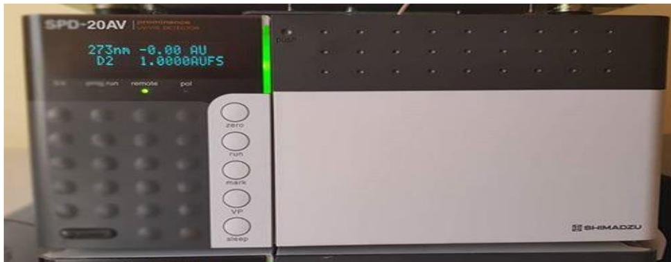
Figure 34 : Détecteur spectrochromatographique UV visible de l'HPLC SHIMADZU .
