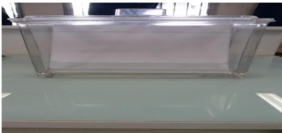
Figure 36 : Chambre de migration et la plaque utilisé pour la CCM
