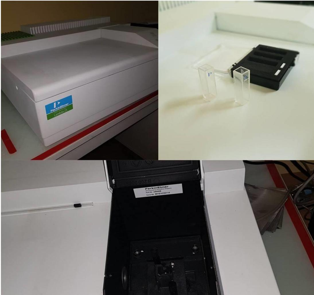
Figure 29 : Spectrophotomètre UV-VISIBLE Perkin ELmer a balayage lambda 25
