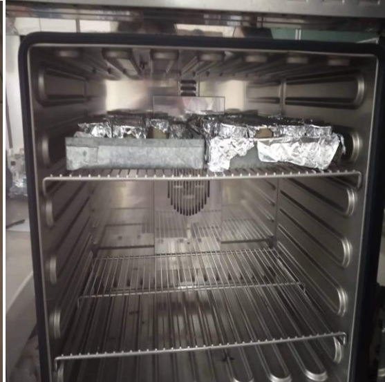
Figure 19 : Mise à l'étuve à 105 ° pendant 48h.
