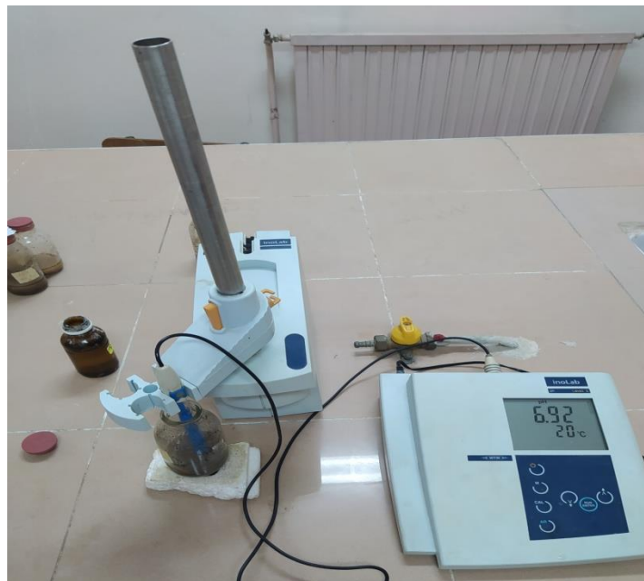
Figure 17 : Mesure du pH du sol à l'aide d'un pH-mètre.
