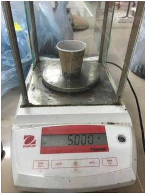
Figure 15 : Pesée du sol échantilloné pour le calcul du pH.
