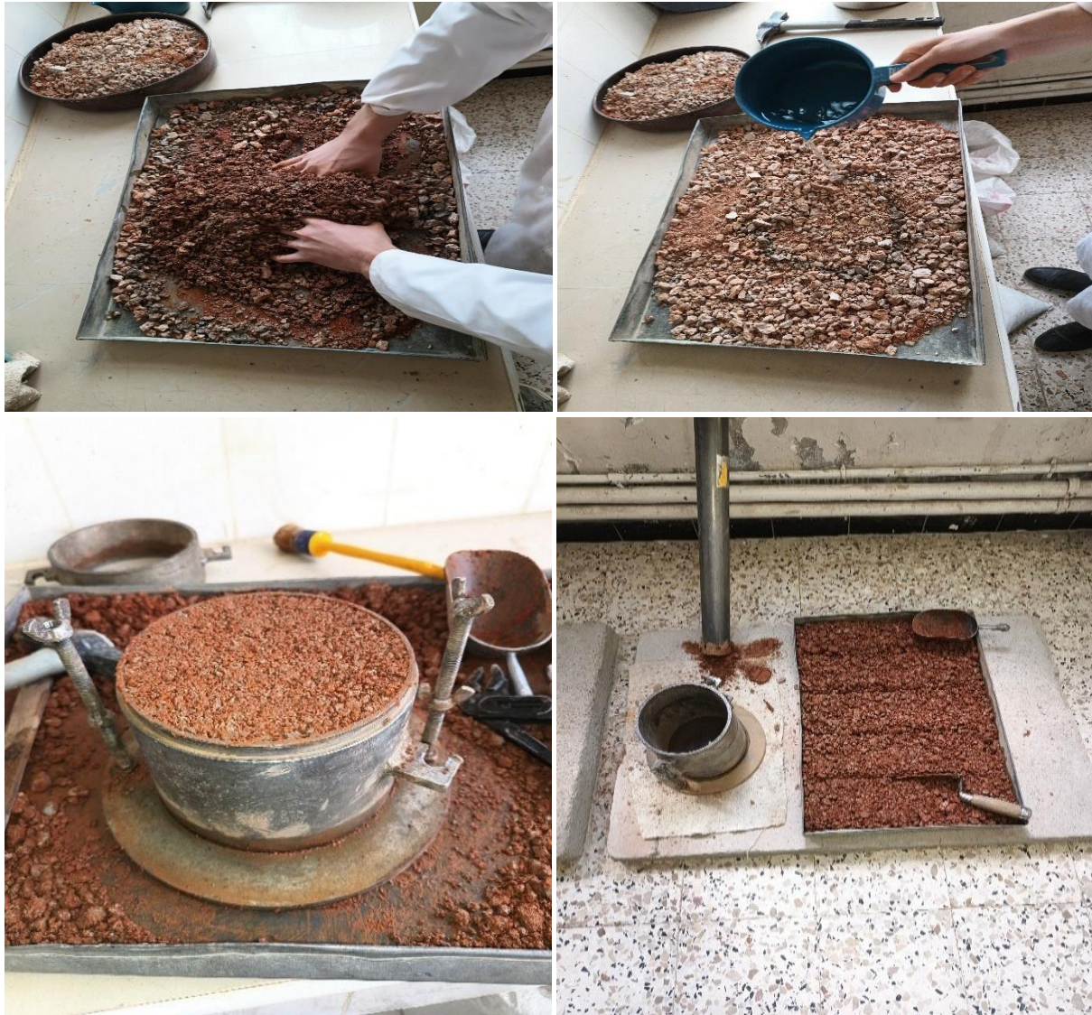
Figure IV.6. Mode opératoire des essais Proctor modifié réalisés.
