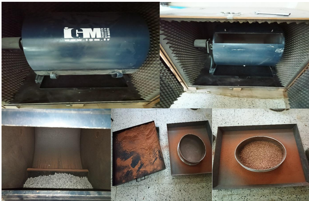
Figure V.5. Mode opératoire de l'essai Los Angeles.
