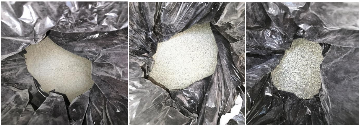
Figure III.11. Tamisage de laitier selon les fractions fin, moyen et grossier.
