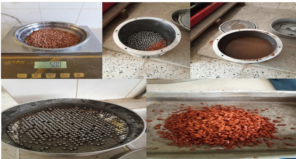
Figure V.2. Mode opératoire de l'essai Micro-Deval.
