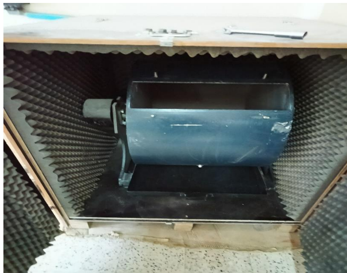
Figure V.4. Machine d'essai Los Angeles.
