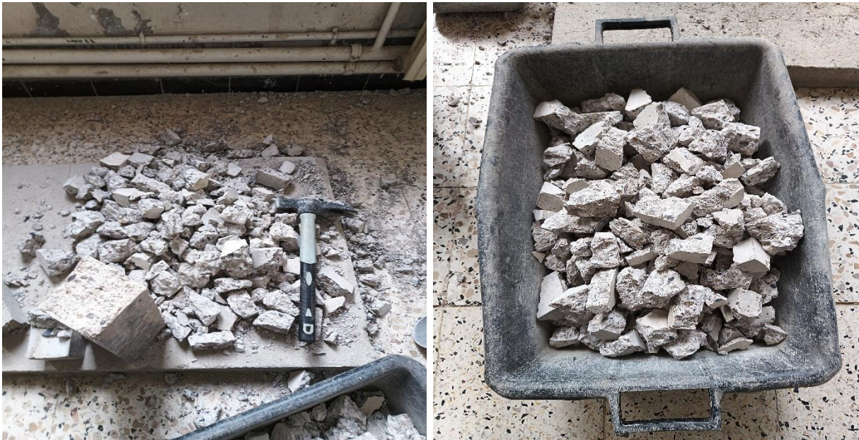
Figure III.1. Les blocs de béton réduits manuellement.
