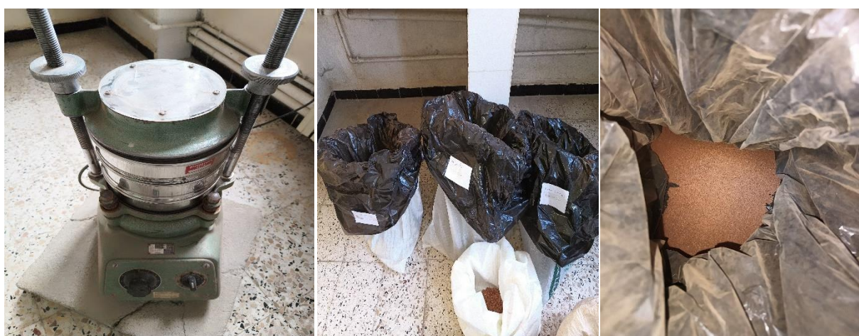
Figure III.7. Tamisage de la brique.
