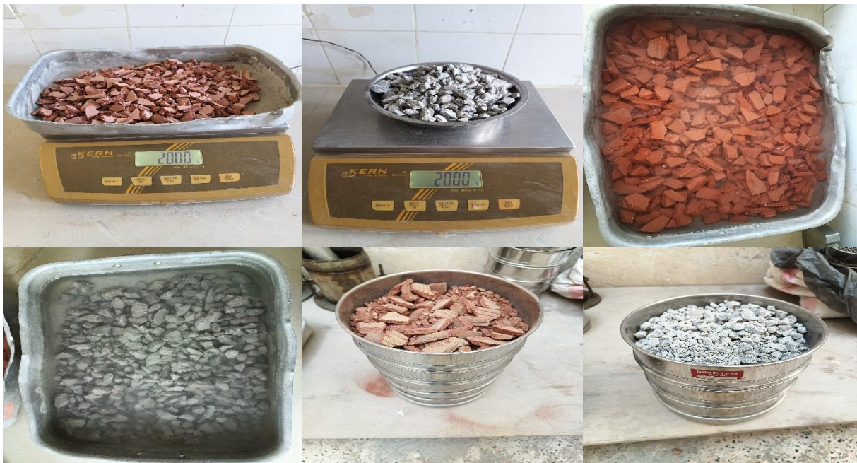
Figure V.7. Mode opératoire de l'essai de dégradabilité.
