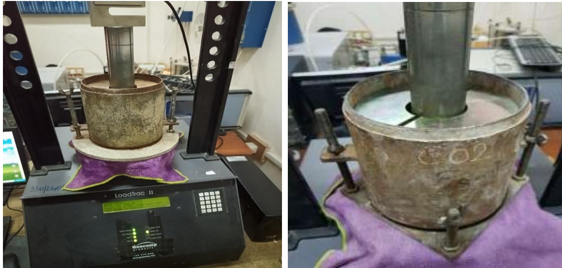
Figure IV.19. Poinçonnement des éprouvettes laboratoire LGEA.
