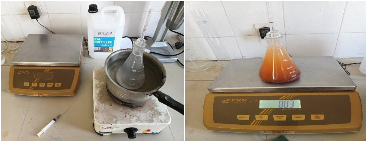
Figure III.9. Exécution de l'essai au pycnomètre.
