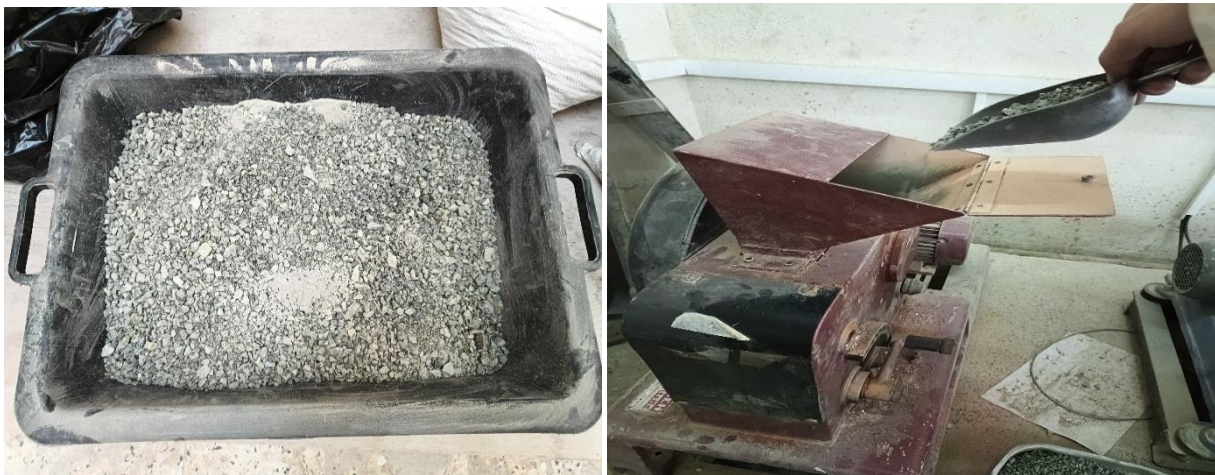
Figure III.10. Broyage de laitier.
