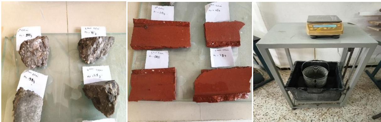
Figure III.8. Mode opératoire (Pesée hydrostatique).
