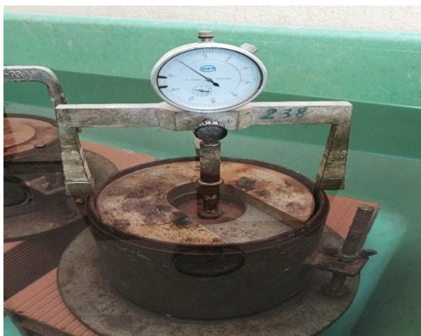
Figure IV.17. Appareillage pour CBR immersion.
