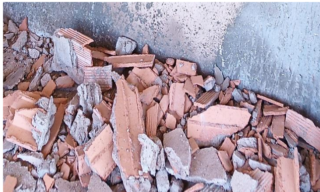
Figure II.10. Déchets de démolition de brique.
