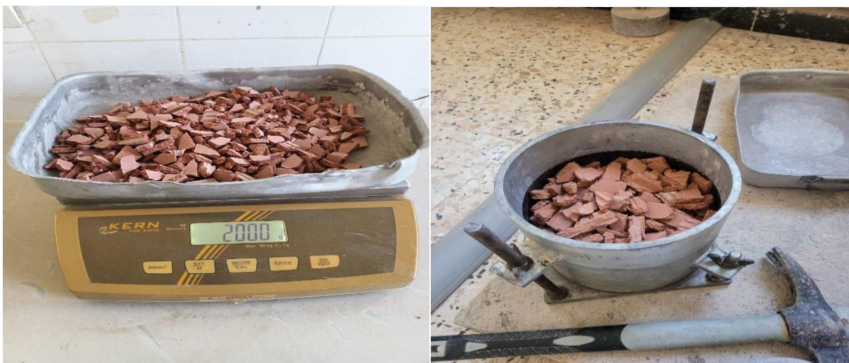
Figure V.10. Pesée et mise du matériau dans le moule CBR.
