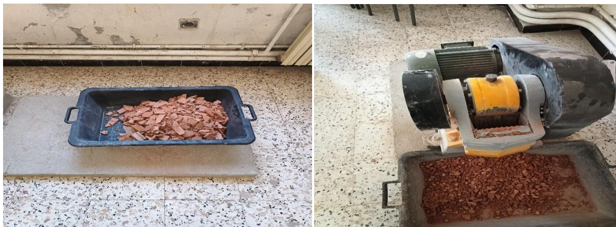
Figure III.6. Concassage de la brique.
