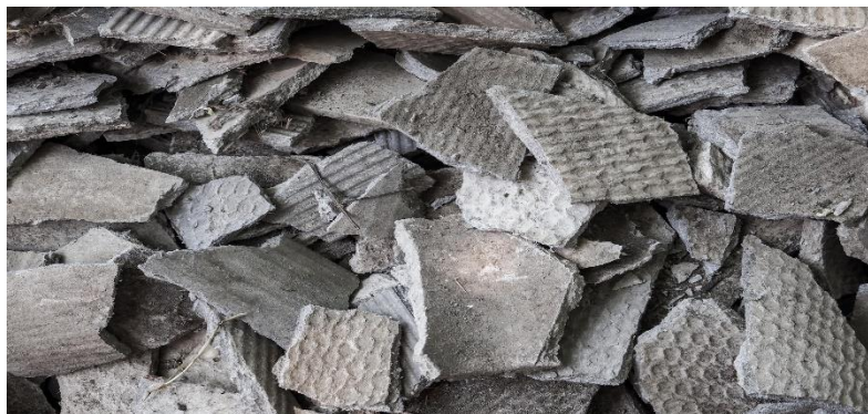
Figure II.8. Déchets de béton contenant de l'amiante.
