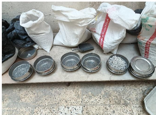
Figure III.5. Tamisage du béton à la main (Dans les cas des petits grains)
