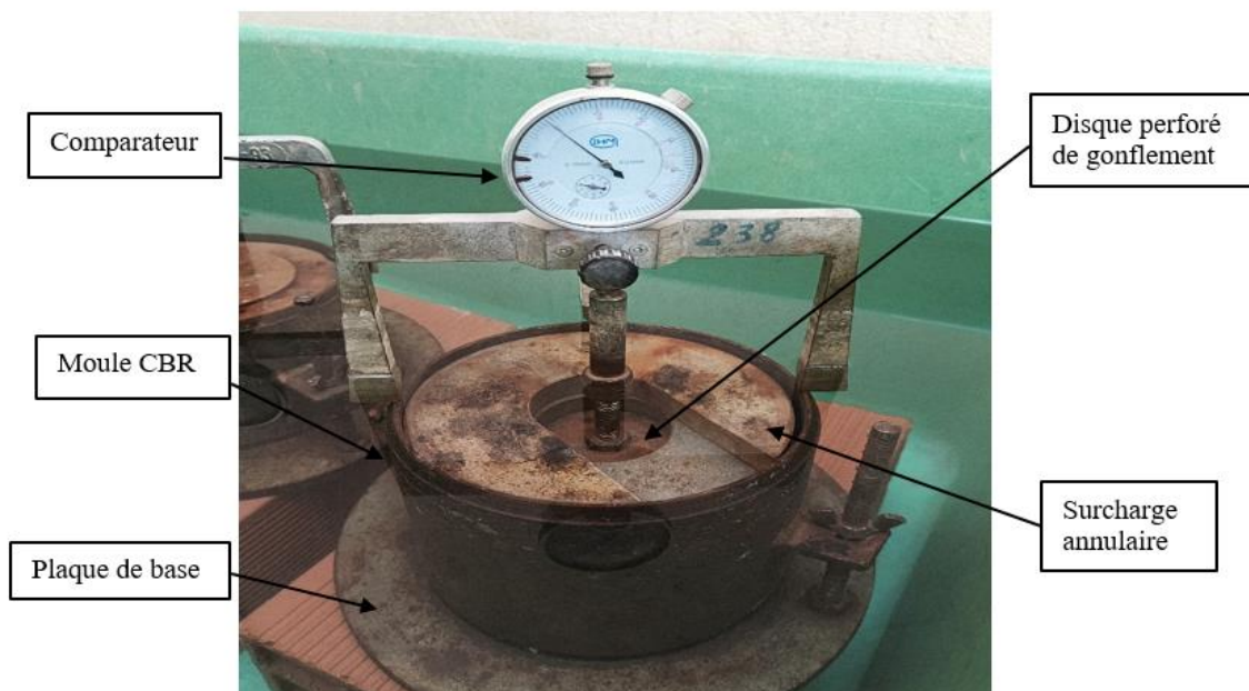
Figure IV.20. Essai CBR après immersion, imbibition et gonflement.
