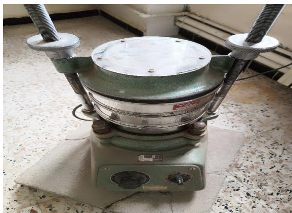
Figure III.4. Tamisage électrique (Dans les cas des gros grains)
