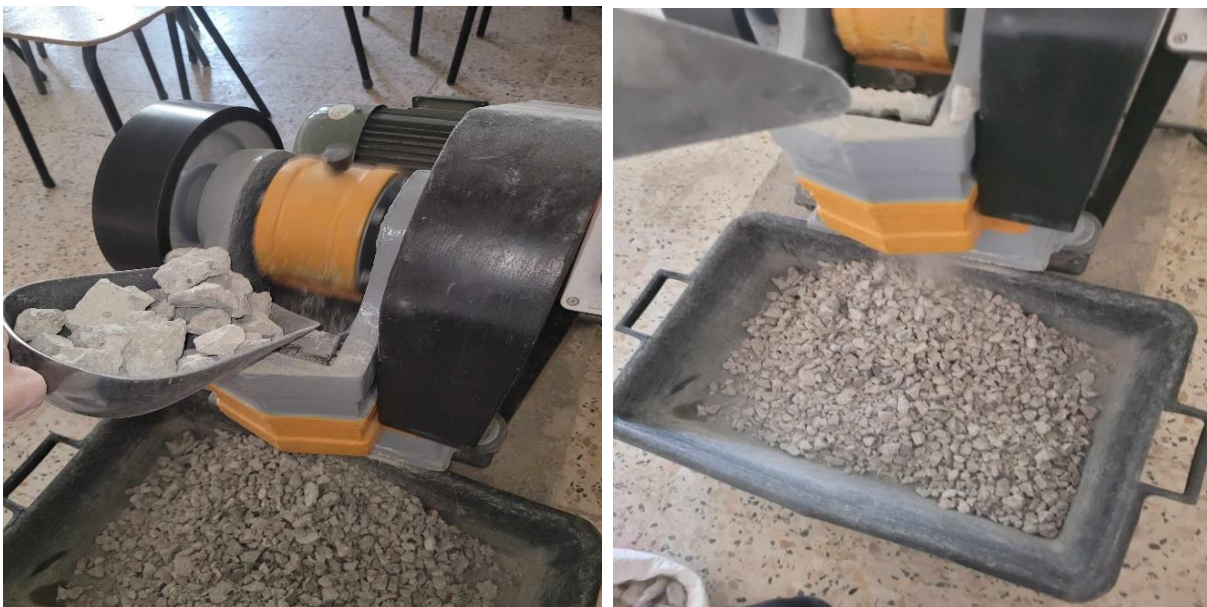
Figure III.2. Concassage du béton au concasseur mécanique.
