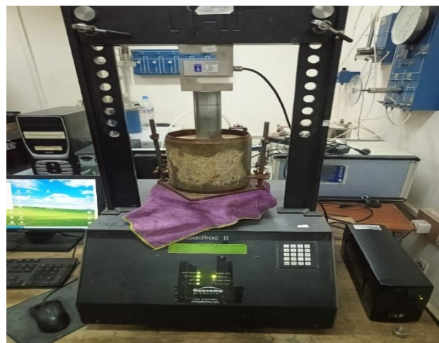
Figure IV.18. La machine de poinçonnement LoadTrac II (LGEA).
