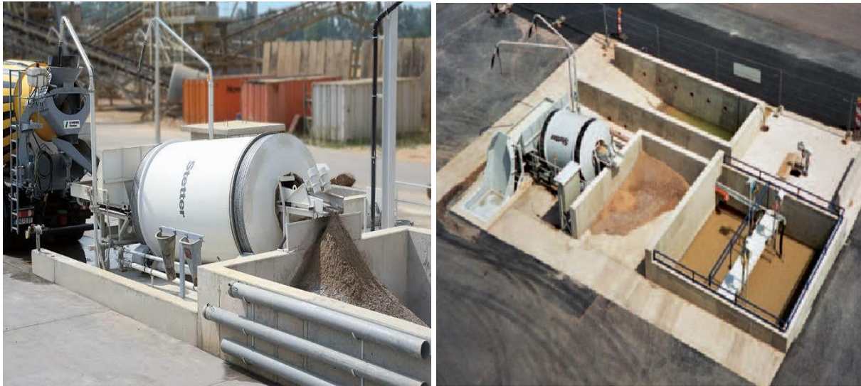
Figure II.15. Centrale de recyclage de béton (Schwing-stetter, 2019)
