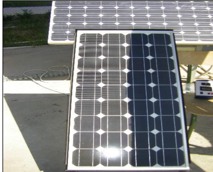
Figure II.15: panneau PV avec défaut d'ombrage partiel à 50%.
