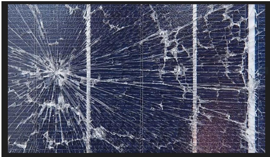
Figure II.9 : Défaut de fissuration d'un panneau PV.
