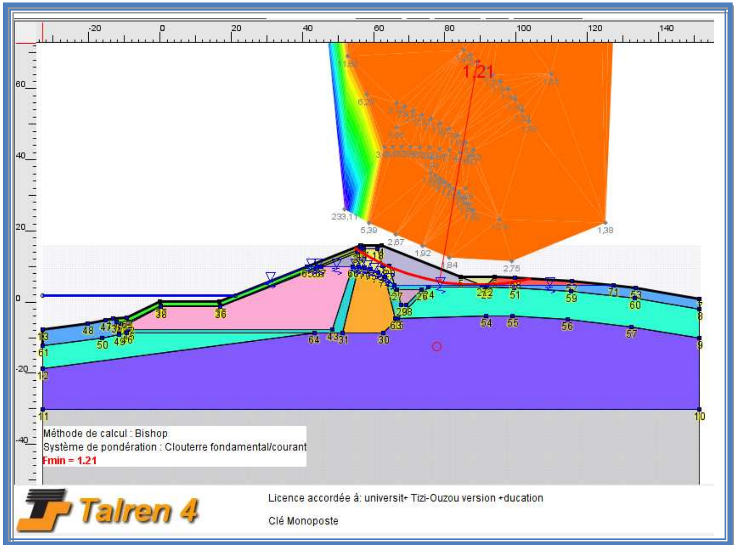
Figure IV.30 :vérification de la stabilité de la digue de col talus aval (avec séisme)
