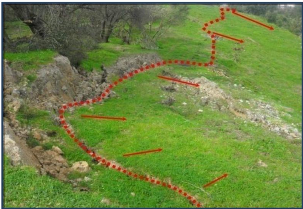
Figure. I. 12: Figure illustrant la niche d'arrachement lors d'un glissement réel Azazga 18/03/2012. Les glissements de terrain se différencient aussi par leur vitesse et par leur profondeur estimée de la surface de glissement.
