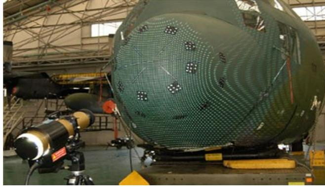
**Figure I.14 : Exemple de cibles projetées par le Prospot1**
