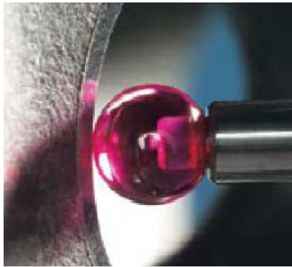
Figure I.2 : Détail d'un palpeur
