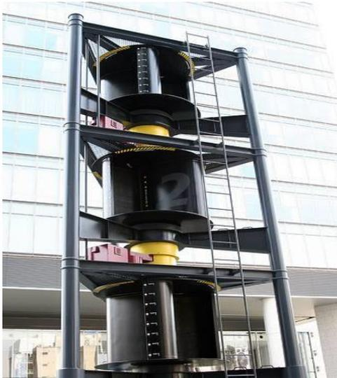
**Figure 1.4 :** Eolienne de type Savonius.
