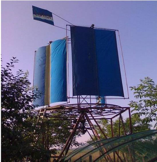
**Figure 1.6 :** Eolienne à voile tournante.
