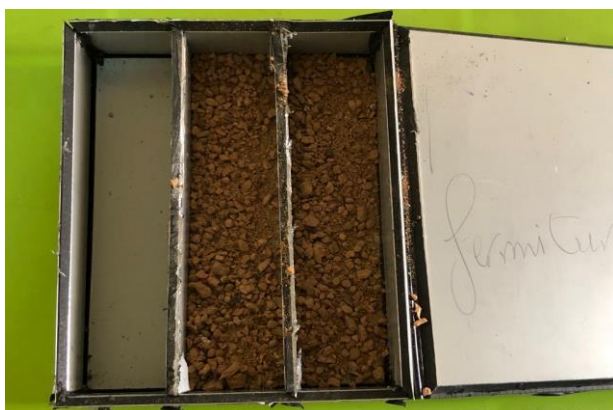
Figure III-14: Coffrage utilisé pour la confection des panneaux
