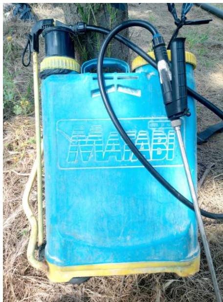
Figure 14 : Pulvérisateur à dos (manuel) de 16L. (original, 2024).
