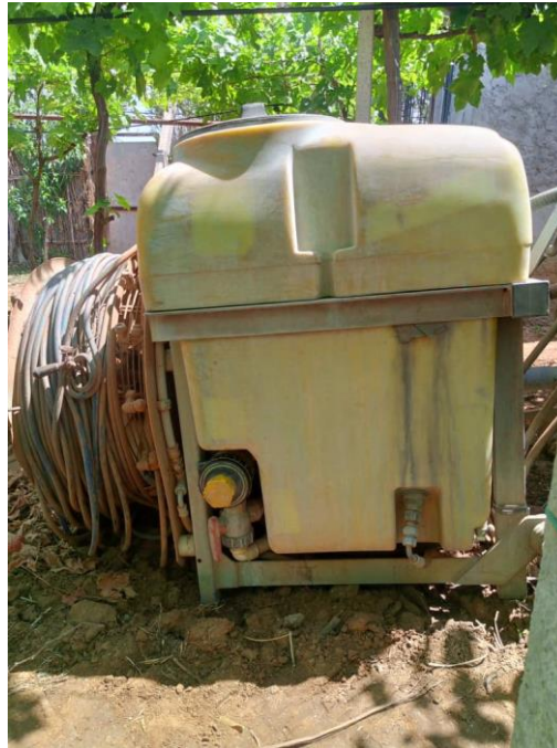
Figure 15 : Pulvérisateur traîné (modern) de 300 L. (original, 2024).
